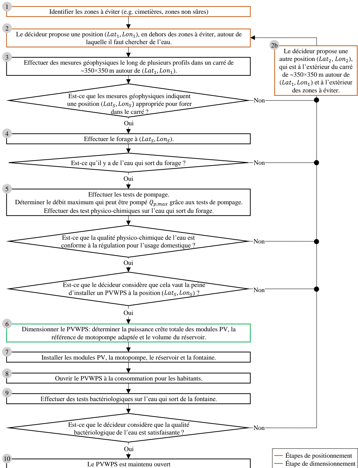
figure 1 – Procédure conventionnelle pour la conception et l'installation de PVWPS.
