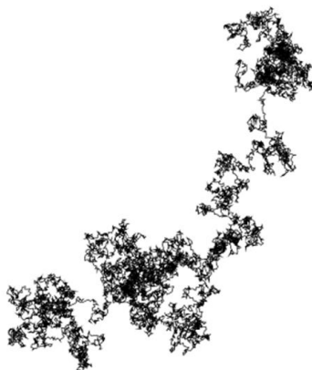
Figure 28 : Mouvement du centre de gravité d'une particule de pollen en suspension révélant le mouvement brownien (Duplantier 2005)
