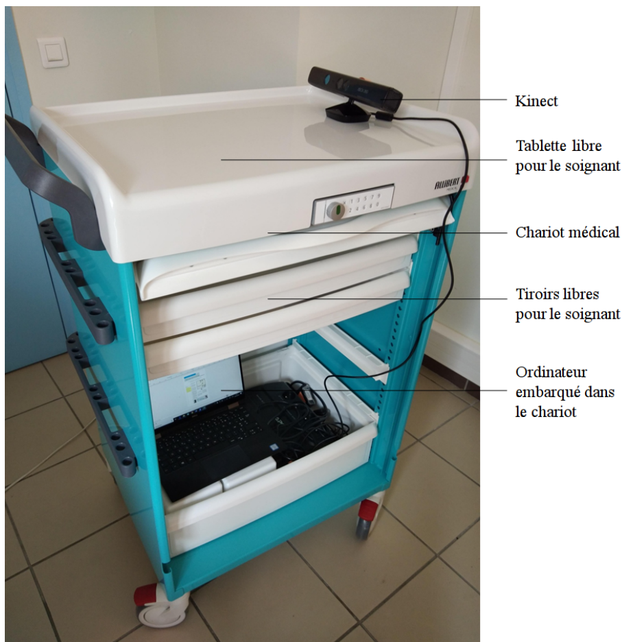
FIGURE 4.4 – Photographie illustrant la mise en place du chariot médical. La kinect positionnée sur le plateau principal du chariot permet de filmer le soignant lorsqu’il rentre et sort de la chambre. En réorientant le chariot durant le soin, la kinect filme l’interaction. Les tiroirs et le plateau peuvent être utiliser pour poser du matériel de soin
