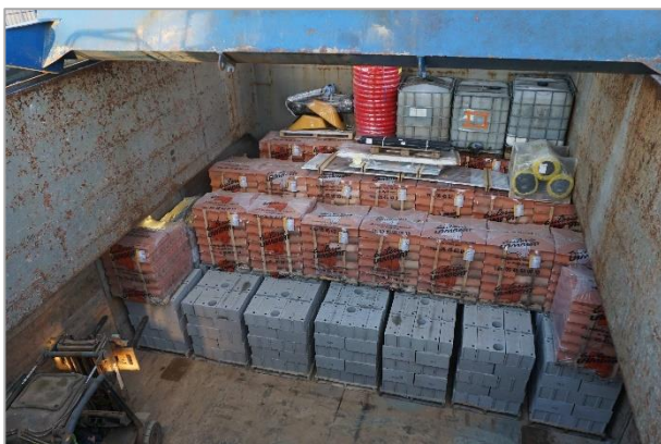
Figure 143 – Le conteneur permet d’harmoniser le format de éléments à charger dans la cale du navire. Port du Stiff, Ouessant (Crédit MG 2016)
