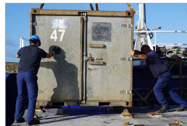
Figure 146 – Les marins de la Penn Ar Bed aident au positionnement d'un conteneur sur ses twist-locks (Crédit MG 2016)
