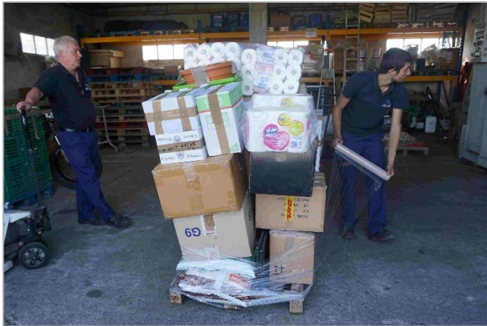
Figure 200 – Opérations de manutention à la gare maritime de Brest Unitisation par palettisation de colis et protection (Crédit MG 2016)
