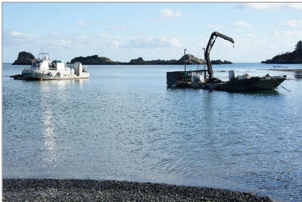
Figure 139 – Moyens de levage de Bréhat Logistique Haut : sur le continent, la grue de 12 T charge un plateau adapté aux dimensions de la barge. Centre : marée basse à la grève de l'Église, le chariot télescopique décharge. Bas : marée haute à la grève de l'Église, la barge et le ponton flottant équipé d'une grue (Crédit MG 2016)
