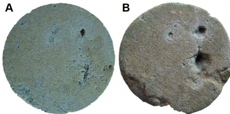
Figure 3.60 : Dégradation de la plaquette 13 par dissolution ( i.e. en surface et sous forme de puits) et par effet mécanique avec rupture d'un morceau au niveau d'une fissure. (A) état initial à t_0 et (B) état final à t_{+2} .
