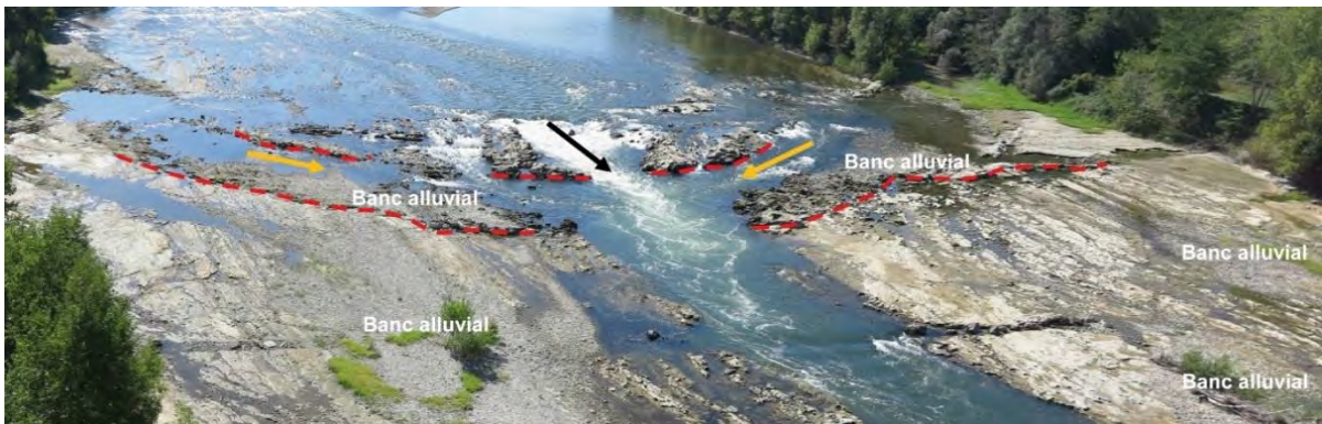
Figure 3.15 : Photographie de l'amont du seuil de Grenade en 2016. Les lignes en pointillés rouges représentent les ruptures de pente entre couches résistante et tendre. Radiers et rapides sont signalés par des flèches orange et noire respectivement.
