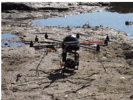
Figure 1.40 : Drone octorotor (Mickrokopter Octo XL) avec appareil photo numérique embarqué (Canon PowerShot G1 X mark II).
