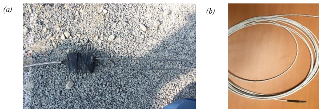
Figure II.3 - (a) sonde d'humidité (b) sonde de température
