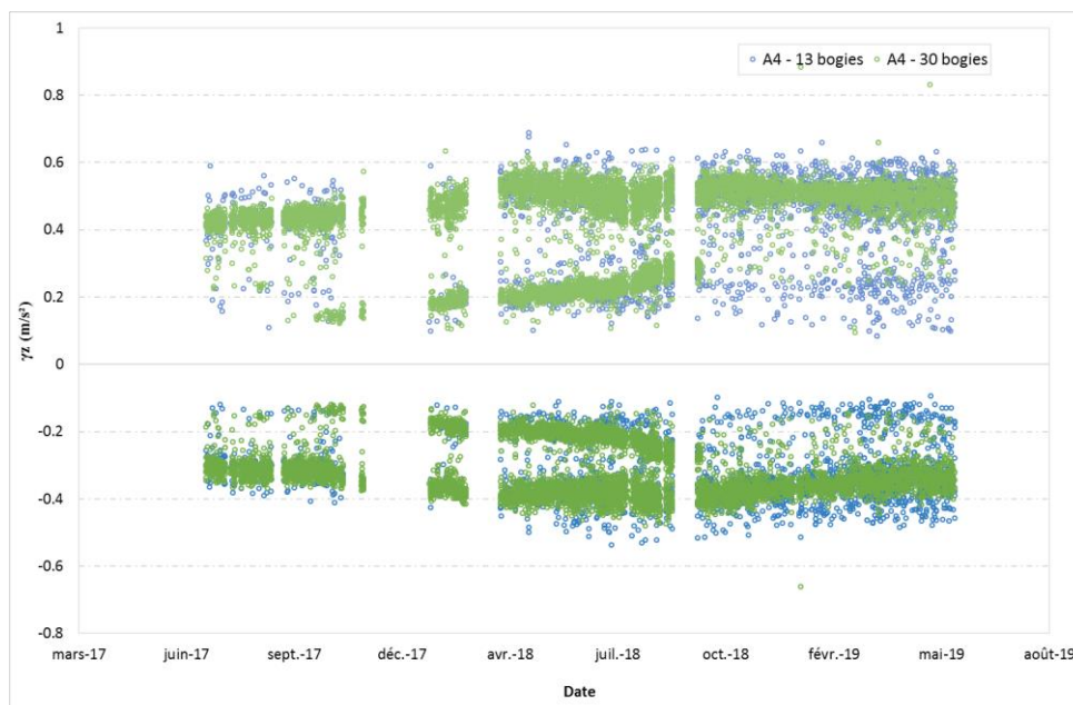
Graphique 29 - Accélérations verticales maximales et minimales mesurées par l'accéléromètre A4 placé entre les deux rails, sur la section bitumineuse 4, pendant la phase d'exploitation commerciale, en fonction du type de train
