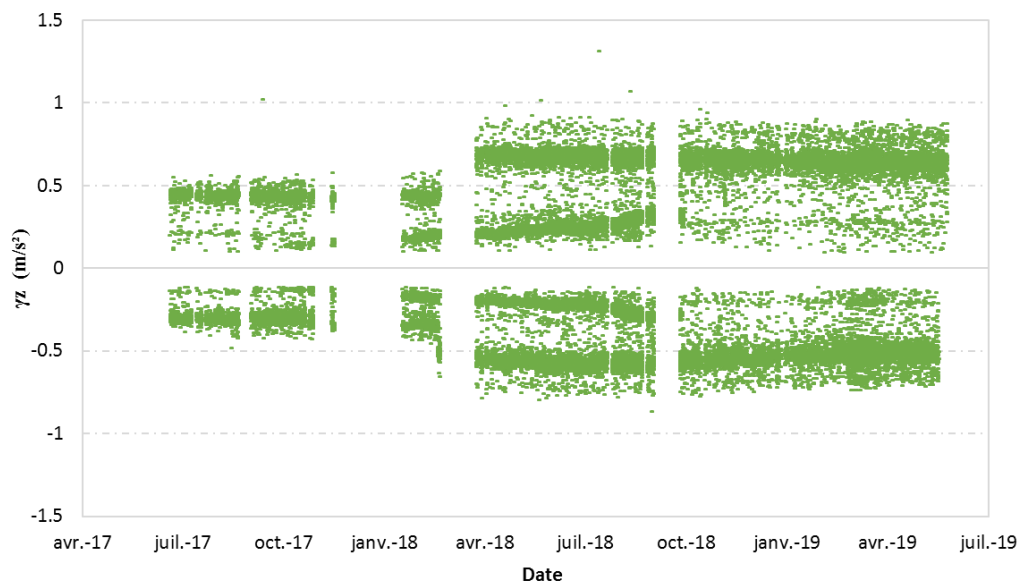
Figure VI.22 - Accélérations verticales maximales et minimales mesurées par l'accéléromètre A6, placé entre les deux rails, sur la section bitumineuse 4, pendant la phase d'exploitation commerciale, par ordre chronologique de passage des trains, sur une durée de 23
