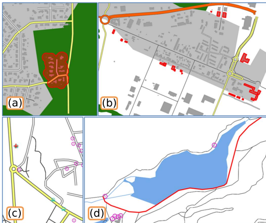
Figure 2-8 Détection automatique de relations spatiales improbables entre objets de LoD différent : (a) ce groupe de bâtiments proches ne peut pas être dans une forêt, (b) la zone bâtie grise devrait inclure les bâtiments en rouge, (c) l'arrêt de bus marqué d'une croix rouge est trop loin de la route, (d) le chemin rouge passe dans le lac (@OpenStreetMap contributors).
