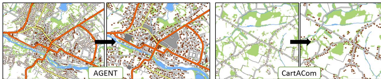
Figure 3-1 Résultats automatiques au 1 : 50 000 des processus AGENT et CartACom obtenus sur la plateforme GeOxygene. Les données « avant » sont issues de la BD Topo, BDG de l'IGN, symbolisées pour le 1 : 50 000.
