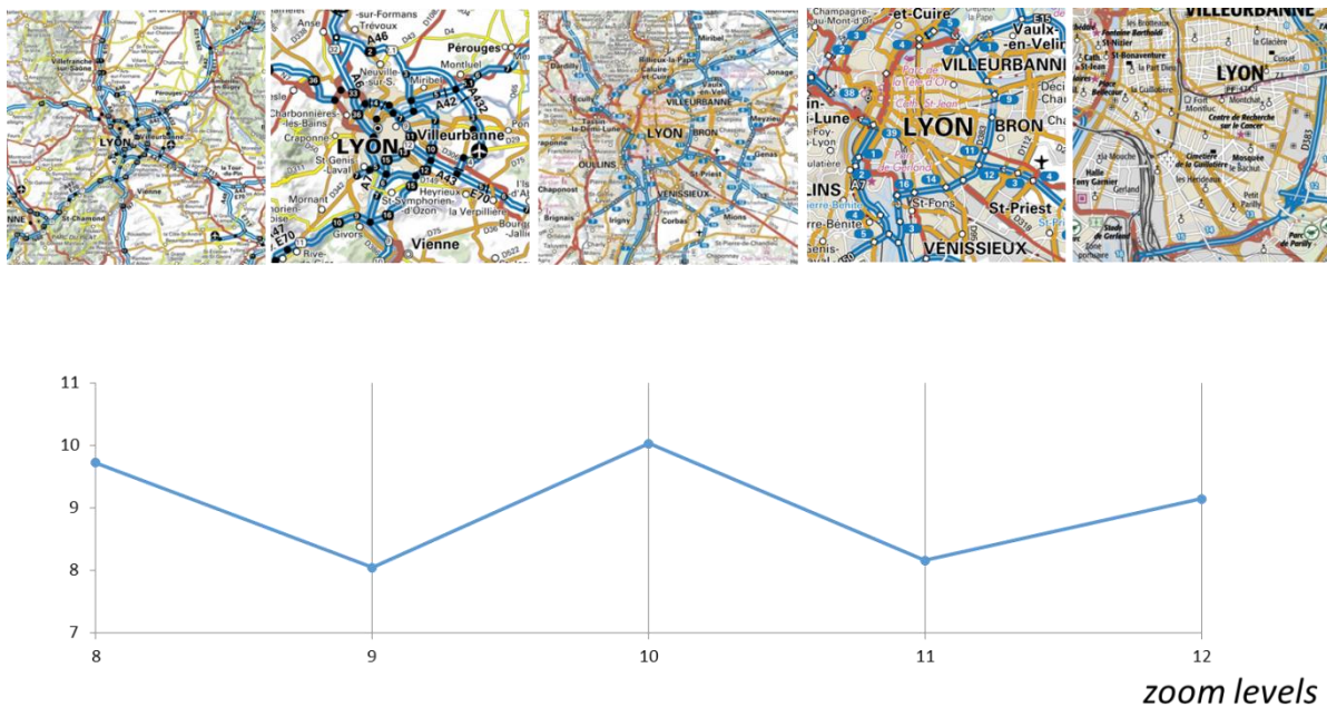
Figure 3-19 Evolution du clutter à travers les niveaux de zooms : la complexité est nettement plus faible aux niveaux où on s'est contenté de grossir une carte adaptée à un autre niveau (Dumont, Touya et Duchêne 2016).
