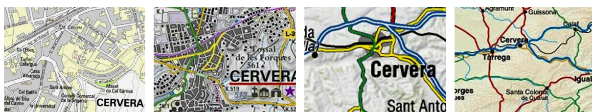
Figure 1-14 Quatre niveaux d’abstraction pour la représentation cartographique du bâti : un polygone par bâtiment individuel, agrégat de bâtiment dans un îlot, un polygone pour toute la zone bâtie, et un point par ville.
