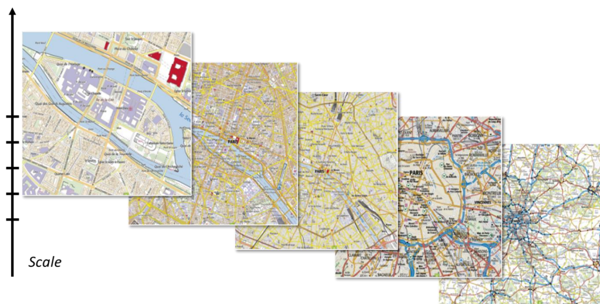
Figure 3-14 Pyramide multi-échelles de l'IGN appelée ScanExpress, avec une certaine continuité dans les légendes et le style.
