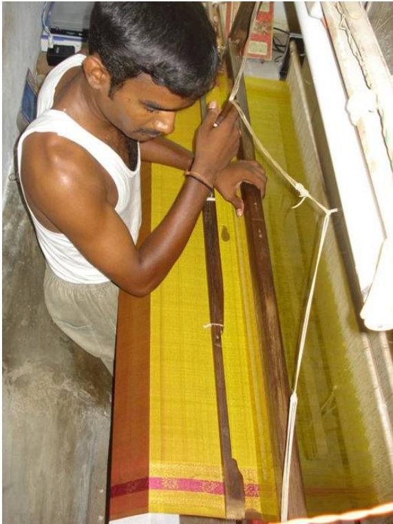
Figure 14: Le métier à tisser à fosse utilisé par les tisserands de Kanchipuram (photo de l'auteur)
