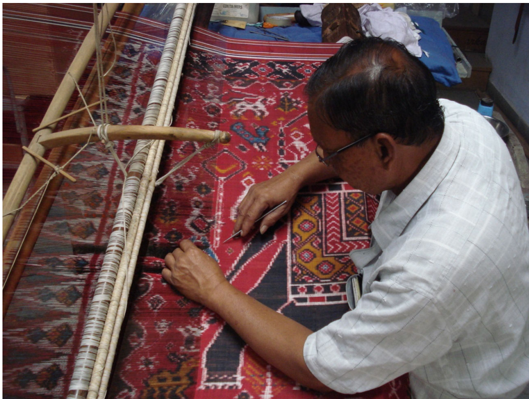
Figure 16: Le tisserand ajuste les fils pour bien aligner la chaîne et la trame (photo de l'auteur)
