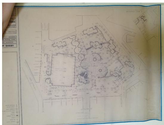
Image 64 : Dessin pour l'aménagement d'une place publique. L'accent sur la végétation et l'aménagement des parvis avec de multiples formes courbes, est représentatif du vocabulaire utilisé pendant les années 70 et 80 au sein des Services techniques de la Ville (Source : image retirée aux Archives de la Direction du Plan de la Ville de la municipalité d'Athènes)
