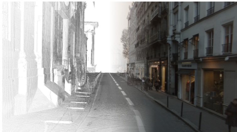
FIGURE 2.2: Superposition d'une image et d'un scan laser mobile de la même scène (avant recalage) [Miled et al., 2016b]
