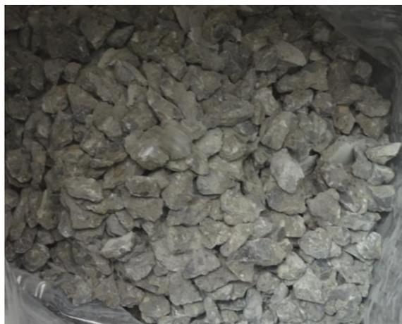
**Figure 2-4 :** Granulat supérieur à 4mm après le premier concassage
