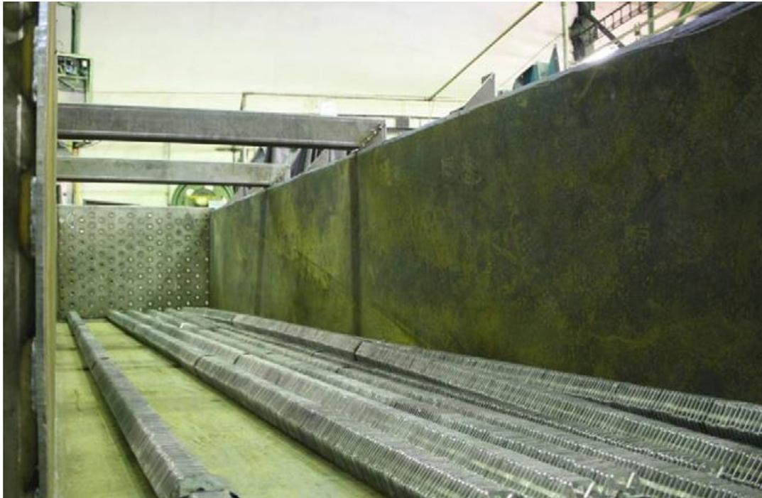
Figure 11 : Le module MCP construit par DLR à Carboneras (Espagne), avant son installation. Sur le sol se trouvent quelques-uns des tubes ailetés [40]
