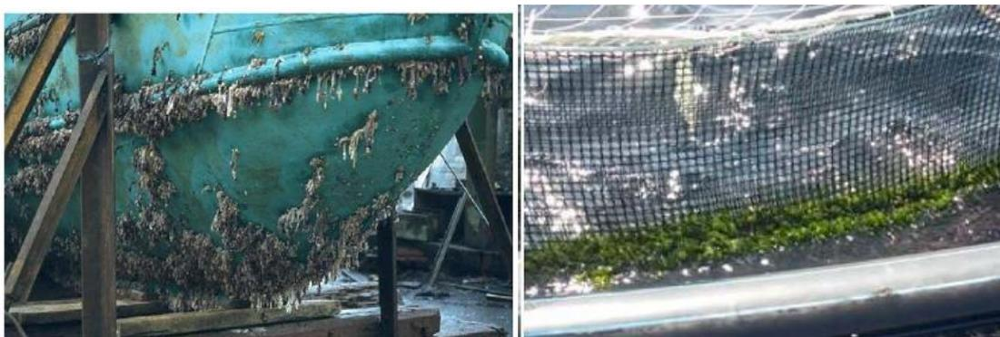
**Figure 3:** surfaces colonisées par le biofouling:(a) coque d'un navire (61); (b) filet colonisé (5)
