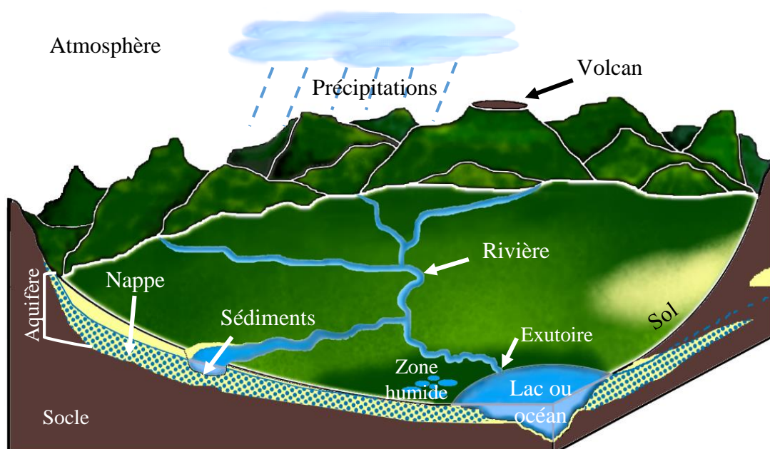
Figure 0.3 : Schéma descriptif du bassin de référence
