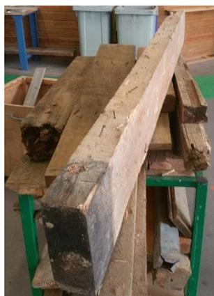
Figure 24 – Exemple d'échantillon avec des clous répartis sur toute la longueur, entraînant un rendement de purge des parties métalliques par tronçonnage de 0 %
