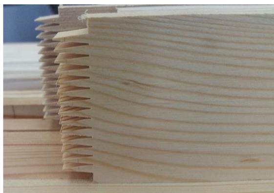
Figure 26 – Lamelles après usinage des entures mâles
