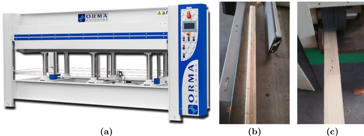
Figure 39 – Type de presse utilisé pour le contre-collage des lamelles (a), état de surface avant corroyage (b) et après corroyage (c)
