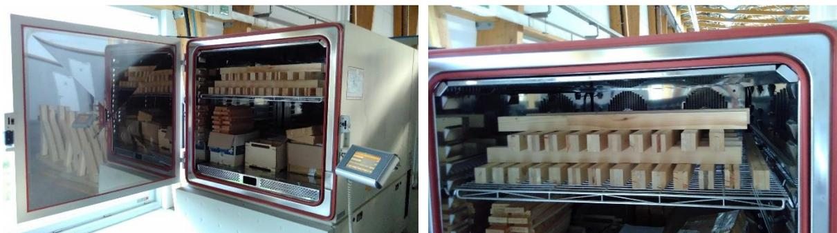
Figure 42 – Conditionnement des carrelets avant essais mécaniques
