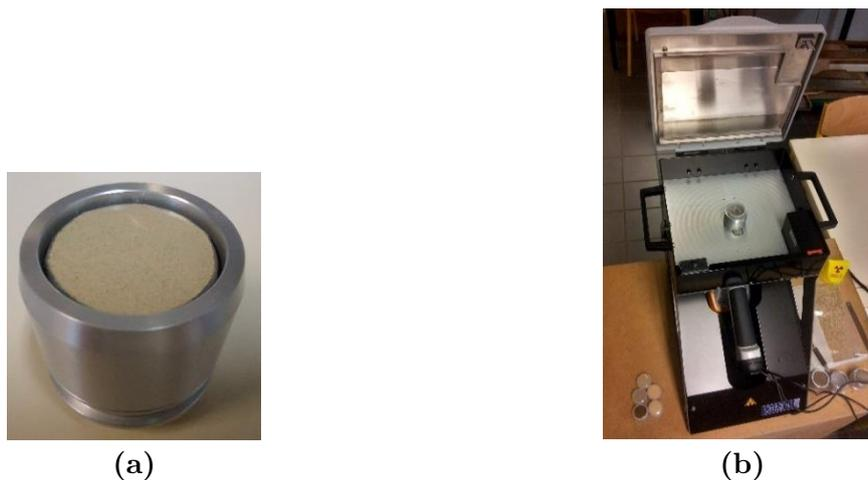
Figure 17 – Dispositif de mesure de la concentration en contaminants dans la sciure de décontamination-délicage ((a) échantillon de farine, (b) spectromètre avec base de paillasse)
