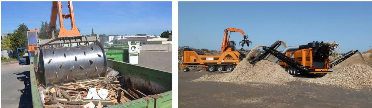
Figure 6 – Matériels utilisés pour le compactage des déchets bois en déchèterie et le broyage et criblage des déchets bois sur plateforme de tri-broyage
