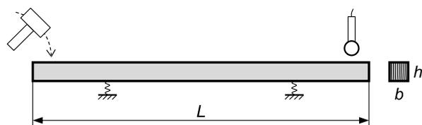
Figure 28 – Principe d'essai pour le module d'élasticité longitudinal (analyse vibratoire)
