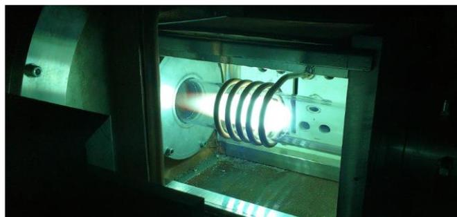
Figure I-7. Photographie du plasma couplé de  $CO_2$  pur.
