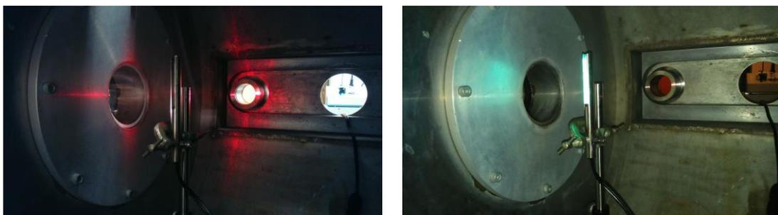
Figure B-29. Positionnement de la lampe crayon pour le réglage du montage spectroscopique.
