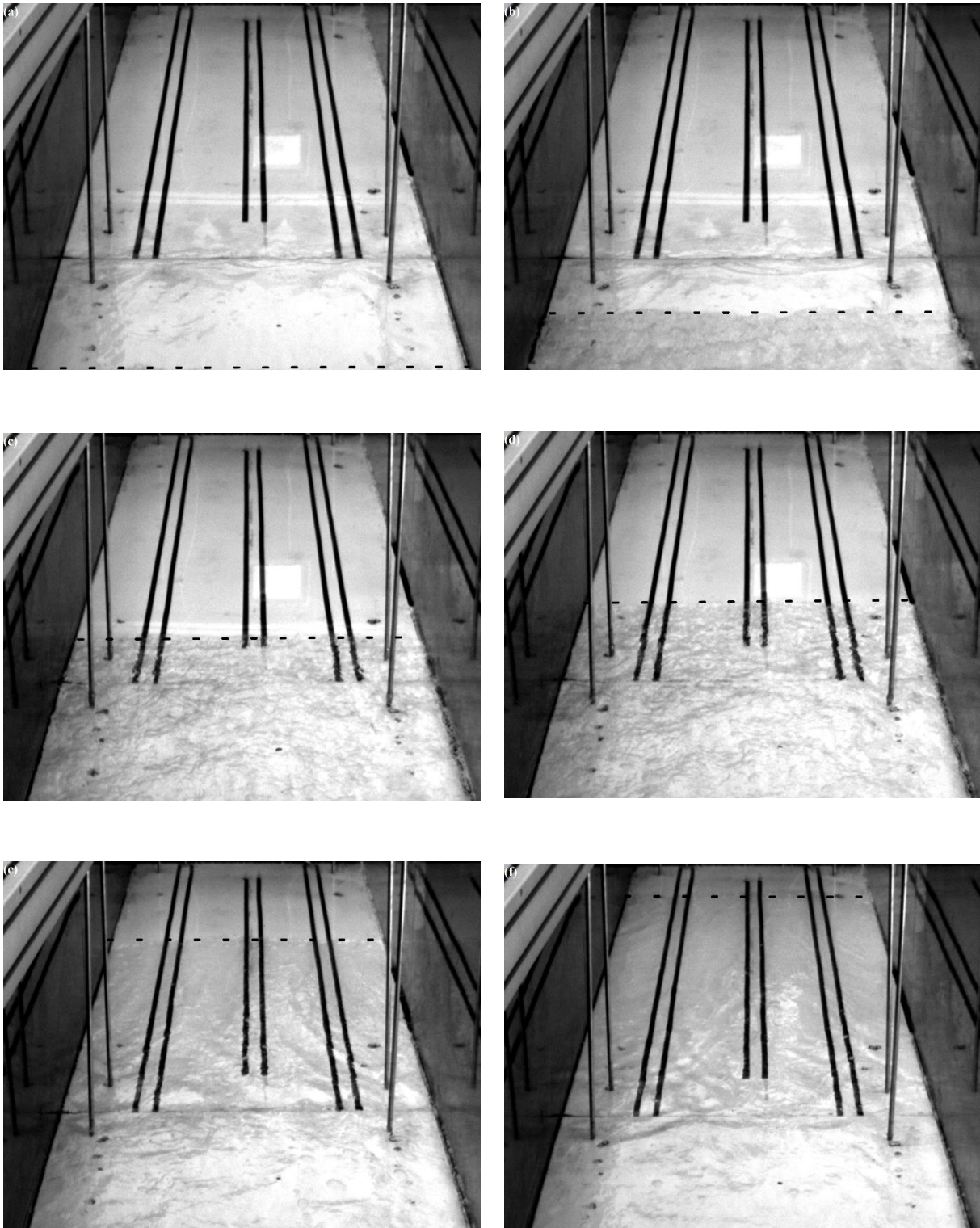
Figure 3.8. Variation temporelle du runup d'une vague solitaire (SW13). (a) : début du runup ( t=0 s) ; (b) : 0,06 s ; (c) : 0,21 s ; (d) : 0,26 s ; (e) : 0,49 s ; (f) : 0,78 s
