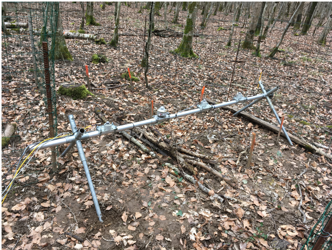
FIGURE 6.16 – Photo du dispositif de mesure du rayonnement incident.
