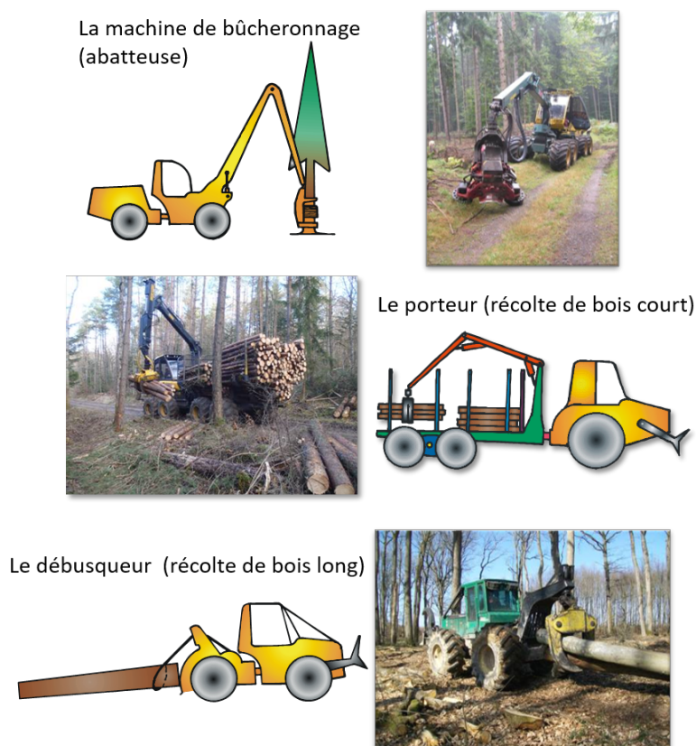
FIGURE 1.1 – Les différents engins d'exploitation forestière les plus courants en France intervenant lors d'une coupe.
