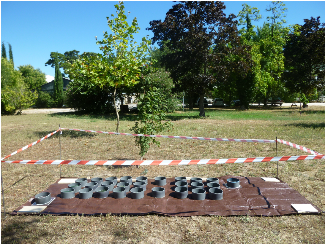
FIGURE 6.20 – Dispositif expérimental réalisé pour étudier la dynamique d'évaporation d'une litière.
