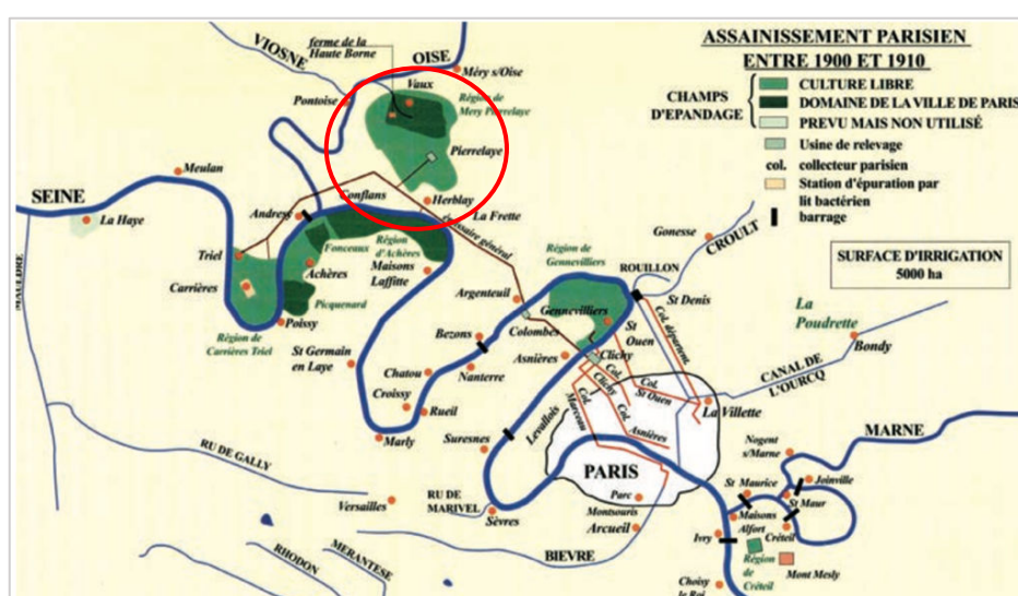
Figure X.1. Représentation du système de l'assainissement parisien au début du XX e siècle. Source : Archives SIAAP
