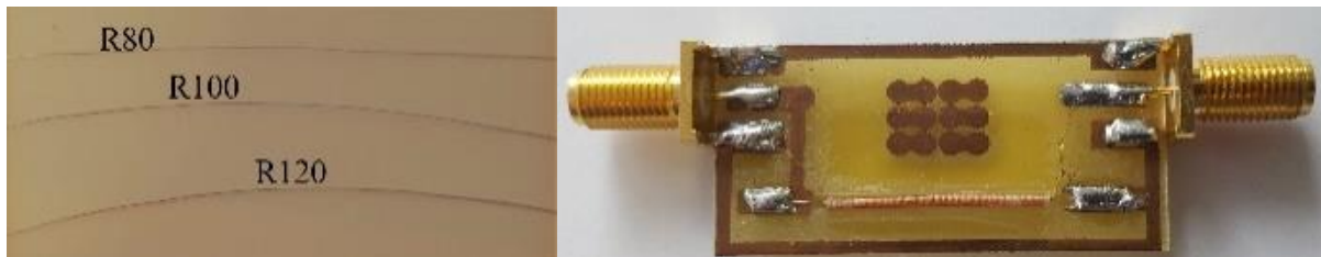
Figure 2.1: Le graph à droite présente 3 échantillons MIG de, respectivement, 80 \mu m (échantillon R80), 100 \mu m (échantillon R100) et 120 \mu m (échantillon R120). Et le graph à gauche, présente une photo du porte-échantillon associé à chaque élément sensible. Il comporte notamment une bobine de capture de 450 tours.
