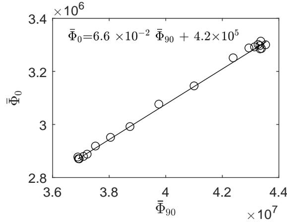
FIGURE 3.27 – Flux de photons mesuré en polarisation parallèle en fonction du flux mesuré en polarisation perpendiculaire pour les différentes masses volumiques obtenues sur un profil de jet froid à  $M_j = 0.9$ .
