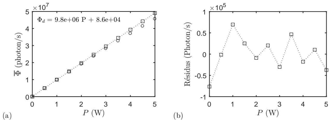
FIGURE 3.18 – (a) : flux de photons compté  $\Phi_c$  (o) en fonction de la puissance incidente, et flux collecté  $\Phi_d$  ( $\square$ ) corrigé avec  $\tau = 1.6$  ns. Les pointillés correspondent à la régression linéaire pour  $\Phi_d$ . (b) : différence entre  $\Phi_d$  et sa régression linéaire.
