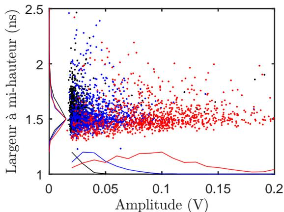
FIGURE 3.10 – Répartition des largeurs de pulse en fonction de l'amplitude pour  $\dots$ ,  $V_{cont} = 0.7$  V ;  $\dots$ ,  $V_{cont} = 0.8$  V ;  $\dots$ ,  $V_{cont} = 0.9$  V. Les lignes représentent les densités de probabilités dans leurs axes respectifs.
