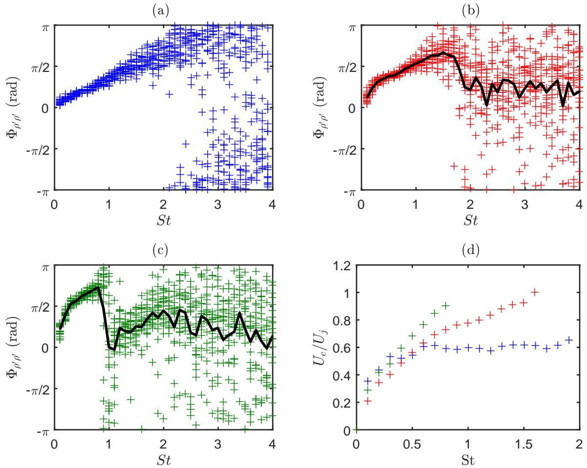
FIGURE 5.18 – (a), (b), (c) : Phase de l'inter-spectre des signaux de masse volumiques mesurés autour de  $z/D = 3$ ,  $y/D = 0.5$  et séparés de respectivement  $0.11D$ ,  $0.21D$ ,  $0.42D$ . (d) : Vitesse de convection déterminée à partir de la phase. — : phase moyenne.
