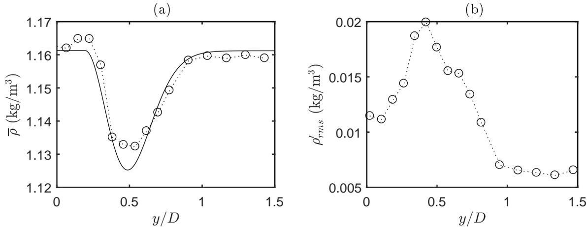
FIGURE 5.9 – Profils de masse volumique dans un jet isotherme à  $z = 3D$  et  $M_j = 0.8$ . — : profil d'après la relation Corcco-Busemann.
