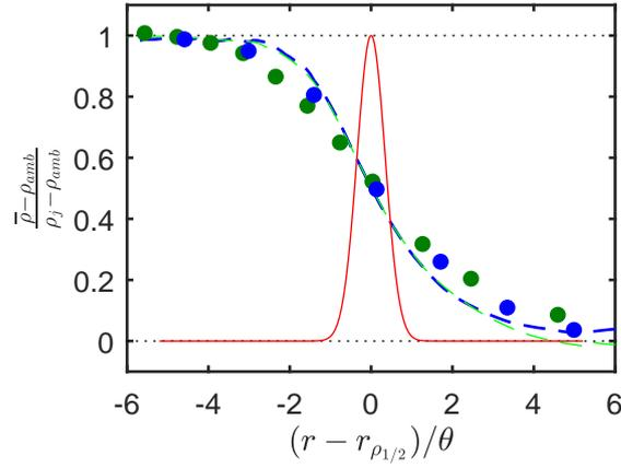
FIGURE 4.15 – Profils de masse volumique normalisés mesurés à  $z = 0.5D$  pour les tuyères C38 (●) et conique (●). Les tirets montrent  $\hat{\rho}$ . Le profil d’intensité du faisceau dont la largeur a été normalisé par  $\theta$  est tracé en rouge.
