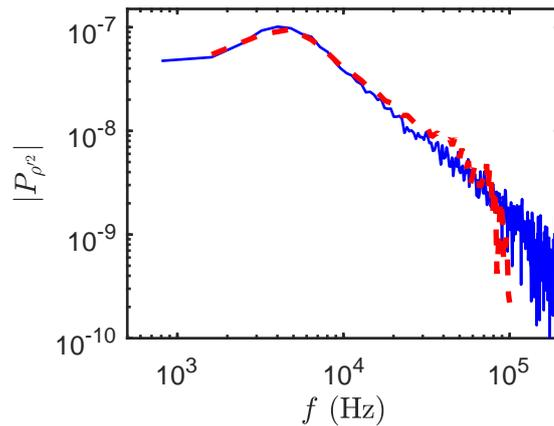
FIGURE 4.2 – Densité spectrale de puissance de  $\rho'$  au pic des fluctuations à  $z = 3D$  dans un jet froid à Mach 0.9 ; présence d'un défaut à haute fréquence. —, DSP calculée à partir de deux PMTs ; - - -, DSP calculée à partir d'un seul PMT.
