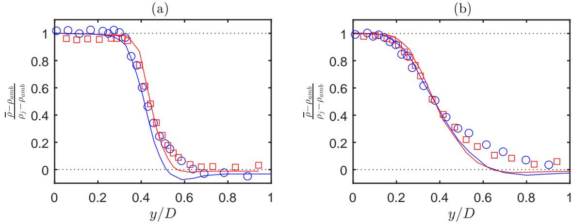
FIGURE 4.8 – Profil de masse volumique à  $z/D = 2$  (a) et  $z/D = 4$  (b) mesurés (symboles), et déterminés par l'équation (4.23) à partir des profil de vitesse PIV (traits continus).  $\circ$ ,  $Mj = 0.7$ ;  $\square$ ,  $Mj = 0.9$
