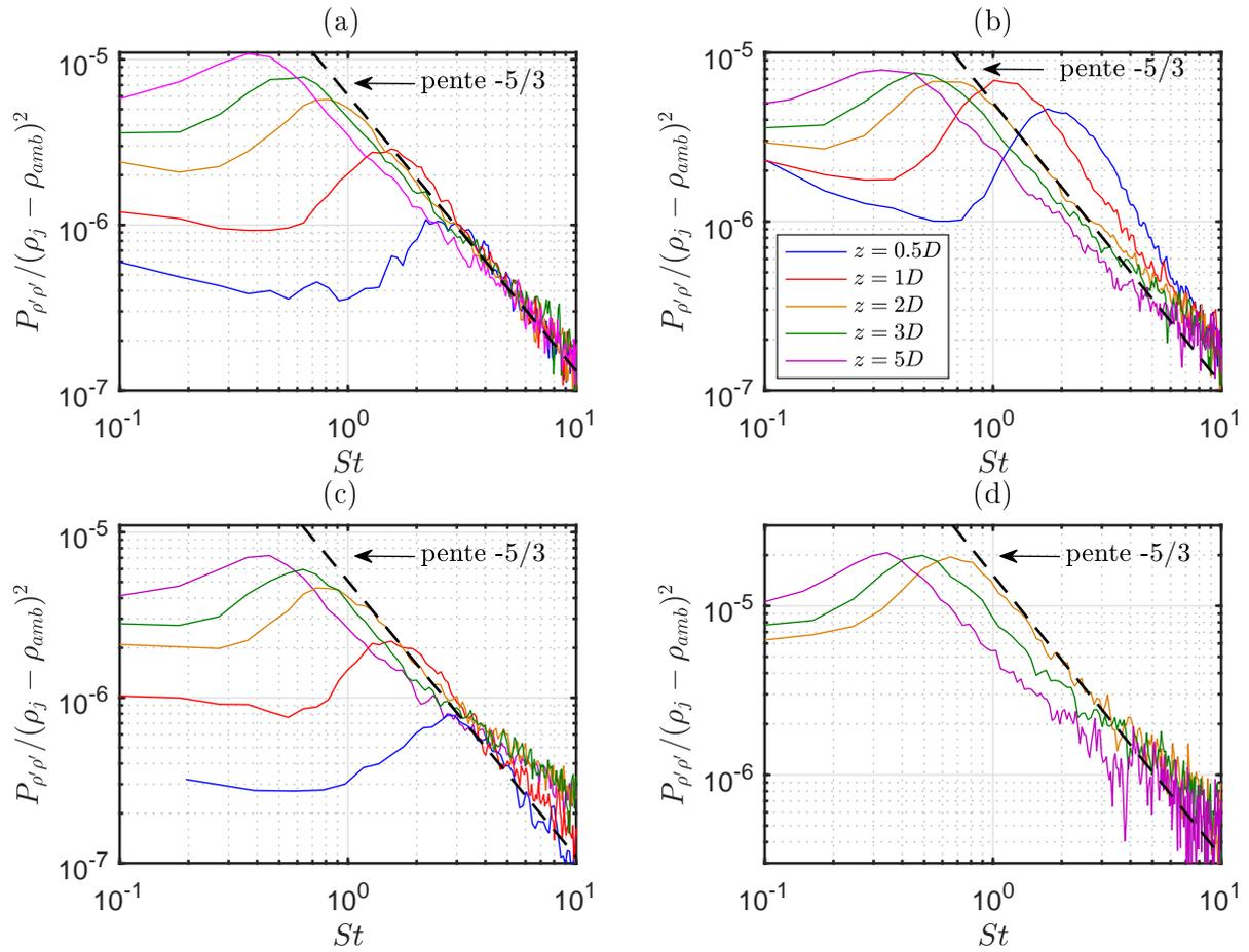
FIGURE 5.3 – Spectres de masse volumique mesurés au pic des fluctuations dans la couche de mélange pour cinq positions axiales. (a)  $M_j = 0.9$  - C38, (b)  $M_j = 0.9$  - ASME, (c)  $M_j = 0.9$  - conique, (d)  $M_j = 0.7$  - C38.
