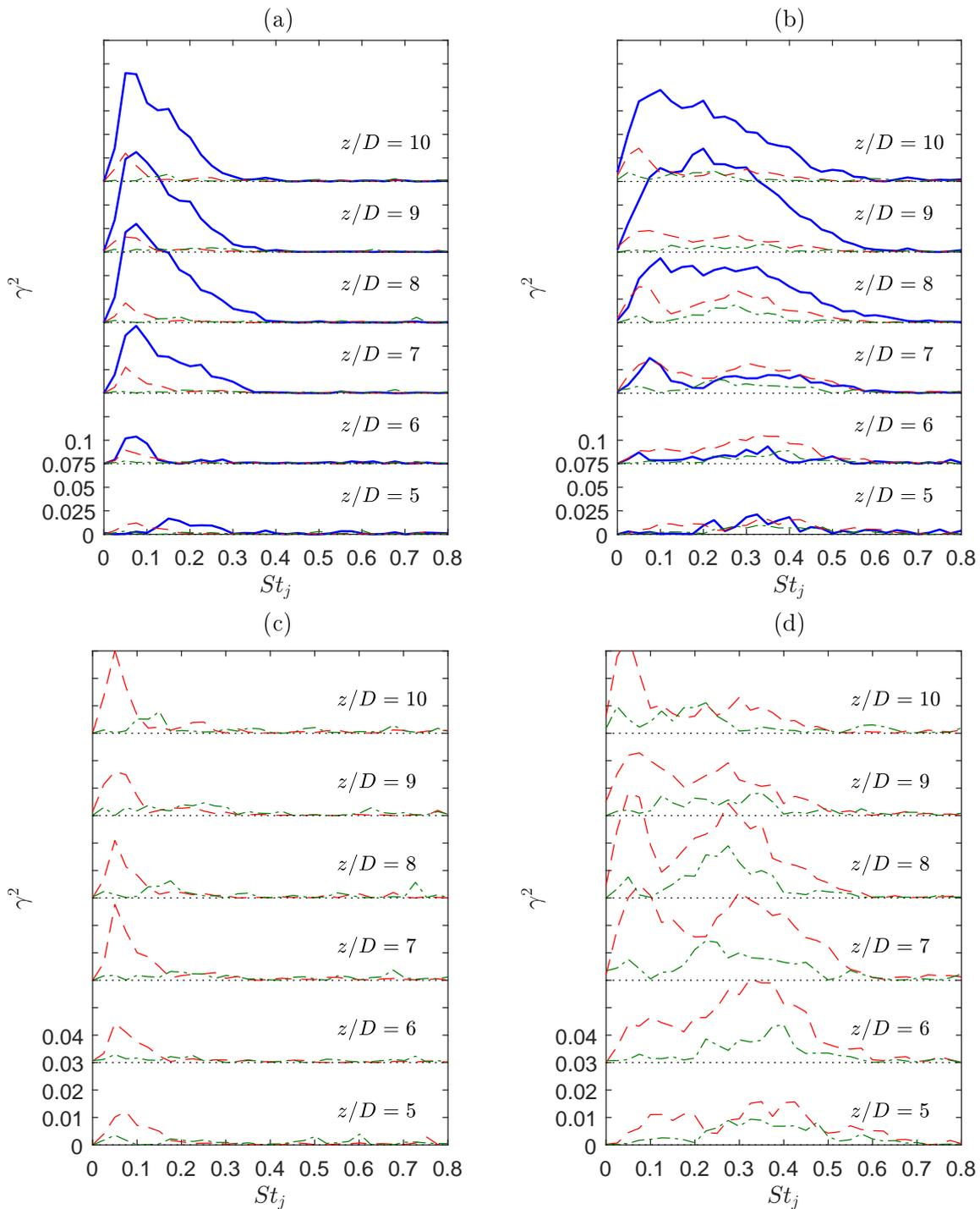
FIGURE 5.26 – Cohérence entre l’acoustique mesuré à  $30^\circ$  et la masse volumique aux positions axiales indiquées pour —  $y/D = 0$ , - - -  $y/D = 0.25$ , - · -  $y/D = 0.5$ . (c) et (d) représentent les mêmes résultats que (a) et (c), mais l’échelle est adaptée pour les faibles cohérences. (a) et (c)  $M_j = 0.9$ , (b) et (d)  $M_j = 1.32$ .
