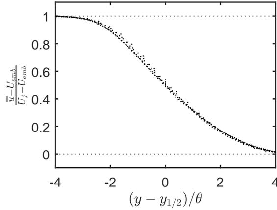
FIGURE 4.9 – Profils de vitesse normalisés par l'épaisseur de quantité de mouvement dans un jet à Mach 0.9 pour  $z/D \in [1 \ 5]$ .
