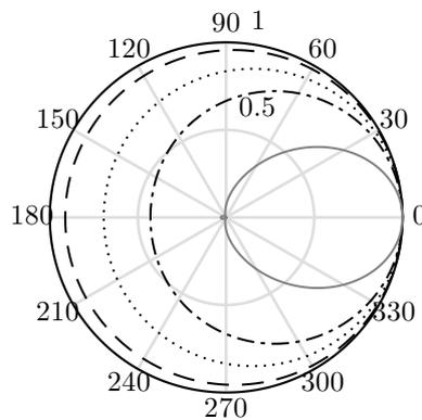
FIGURE 2.5 – Directivité de diffusion en polarisation perpendiculaire pour différents diamètres de particules. L’angle vaut  $0^\circ$  pour un observateur aligné au faisceau et observant la source. —  $d=0.01\lambda$ , — — —  $d=0.1\lambda$ , ···  $d=0.2\lambda$ , - · -  $d=0.3\lambda$ , — — —  $d=0.63\lambda$
