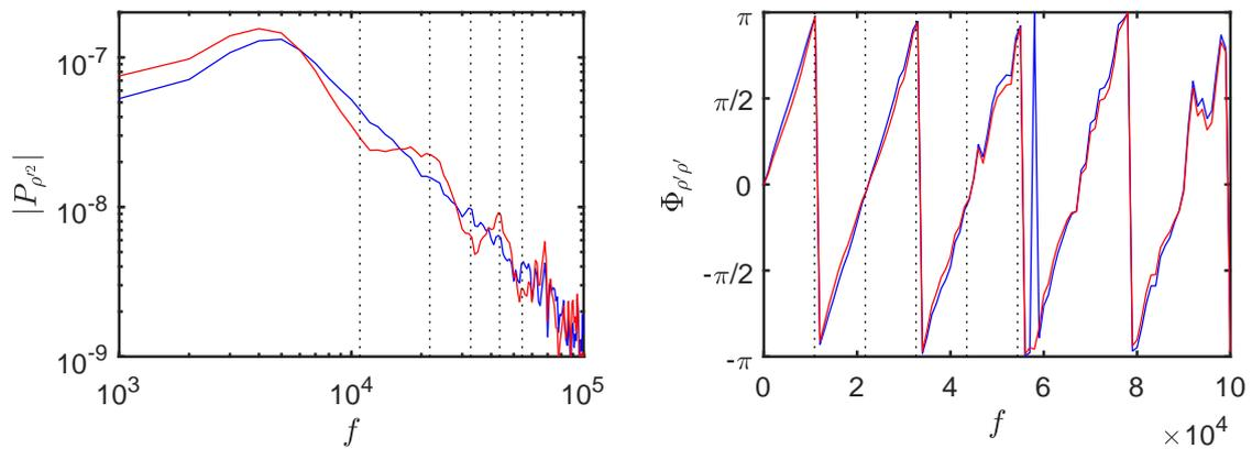
FIGURE C.2 – (a) Spectres de  $\rho_1'$  (—) et  $\rho_3'$  (—). (b) Phase entre  $\rho_2$  et  $\rho_1$  (—) et entre  $\rho_3$  et  $\rho_1$  (—). Les pointillés identifient  $f_c^k$  avec  $k = 1, \dots, 5$ .
