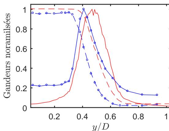
FIGURE 4.19 – Profils radiaux de :  $-\cdot-$ ,  $(\bar{\rho} - \rho_{amb})/(\rho_j - \rho_{amb})$ ;  $-$ ,  $\rho'_{rms}/\text{Max}(\rho'_{rms})$ ;  $-\cdot-$ ,  $u/U_j$ ;  $-$ ,  $u'_{rms}/\text{Max}(u'_{rms})$ .  $z/D = 2$ ,  $M_j = 0.9$ ,  $T_0 = 29.7^\circ\text{C}$ ,  $T_{amb} = 19.6^\circ\text{C}$ , tuyère C38.
