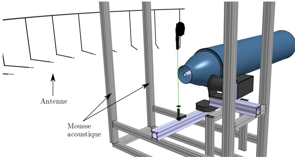
FIGURE 5.22 – Vue CAO du dispositif utilisé pour les corrélations entre  $\rho'$  et  $p'$  en champ lointain.
