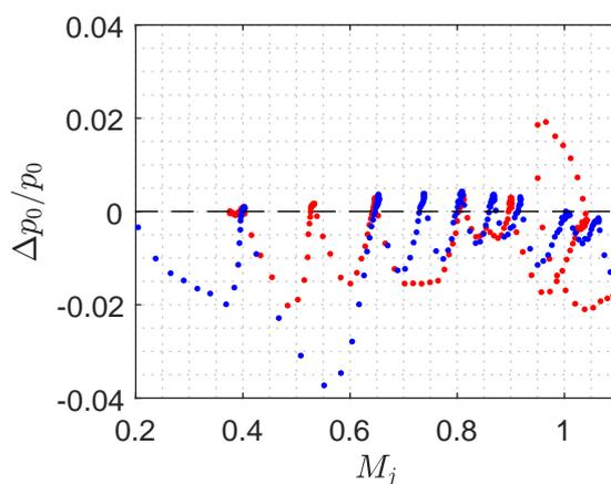
FIGURE B.2 – Erreur relative entre la pression totale estimée via la pression statique dans la conduite, et la pression totale mesurée dans le jet.  $\cdot\cdot\cdot$ , Tuyère C38 ;  $\cdot\cdot\cdot$ , ASME
