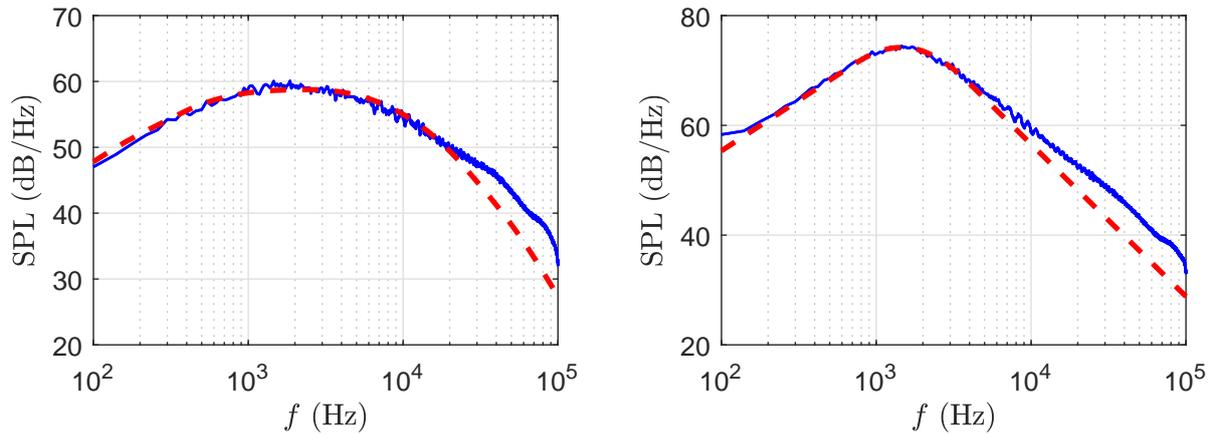
FIGURE 1.4 – Spectre acoustique d'un jet à Mach 0.9 à  $90^\circ$  de l'axe du jet (gauche) et  $30^\circ$  (droite). —, mesures ; - - -, spectres universels.
