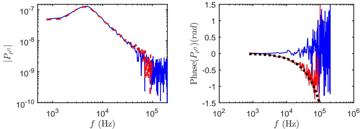
FIGURE 4.1 – Gauche : Densité spectrale de puissance de  $\rho'$  au pic des fluctuations à  $z = 3D$  dans un jet froid à Mach 0.9. —, DSP calculée à partir de deux PMTs ; - - -, DSP calculée à partir d'un seul PMT. Droite, phase des inter-spectres.  $\dots$  :  $\phi(f) = \frac{-2\pi f}{f_s}$
