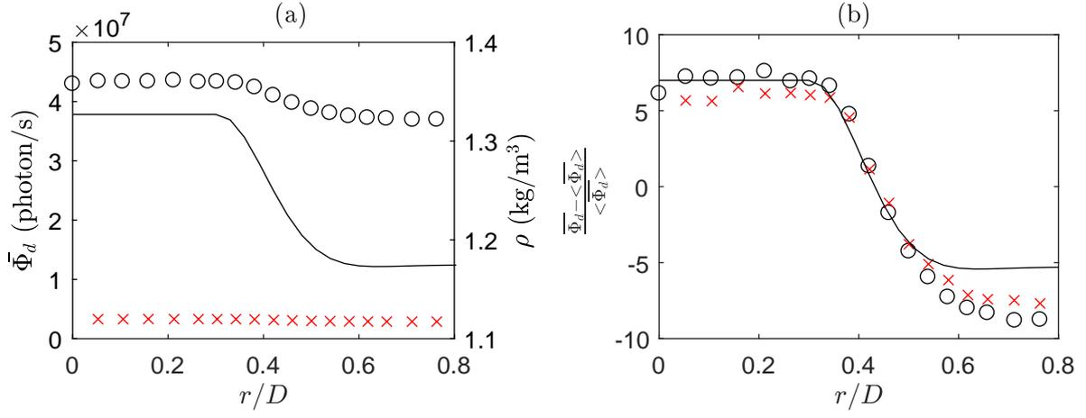
FIGURE 3.26 – (a) : Profil du flux de photons mesuré dans un jet à nombre de Mach 0.9 en polarisation parallèle et perpendiculaire. (b) : écart relatif au flux moyenné sur tout le profil.  $\circ$   $\phi = 90^\circ$ ,  $\times$   $\phi = 0^\circ$
