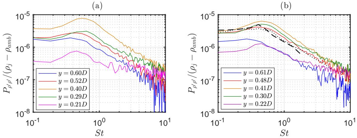
FIGURE 5.6 – Spectres de masse volumique mesurés à Mach 0.9 à  $z = 3D$  aux positions radiales indiquées dans la légende. (a) tuyère C38, (b) tuyère ASME.  $\cdots$  Spectre de vitesse à  $y = 0.5D$ ,  $z = 3D$ , avec la tuyère ASME simulé par Bogey et Marsden [14];  $---$  spectre à  $y/D = 0.4$  et  $M_j = 1.2$  mesuré par Kerhervé *et al.* [47] (niveaux arbitraires).
