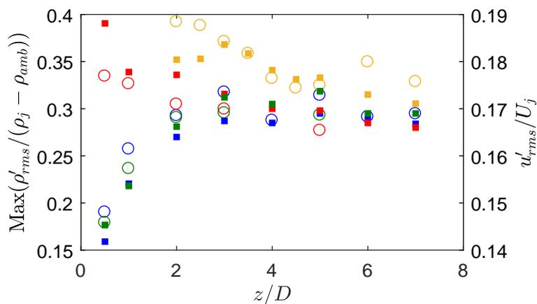
FIGURE 4.20 – Maxima des fluctuations de masse volumique ( $\circ$ ) et de vitesse axiale ( $\square$ ) en fonction de la position axiale.  $M_j = 0.9$  :  $\bullet$ , tuyère C38 ;  $\bullet$ , tuyère ASME ;  $\bullet$ , tuyère conique.  $M_j = 0.7$  :  $\bullet$ , tuyère C38.
