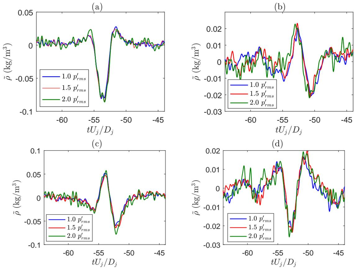
FIGURE 5.31 – Moyennes conditionnées de  $\rho$  basée sur les maxima (a)-(b) et les minima (c)-(d) de pression acoustique mesuré à  $30^\circ$  pour les seuils indiqués dans la légende.  $M_j = 1.32$ ,  $z = 9D$  et  $y = 0$  (a)-(c),  $y = 0.50D$  (b)-(d).
