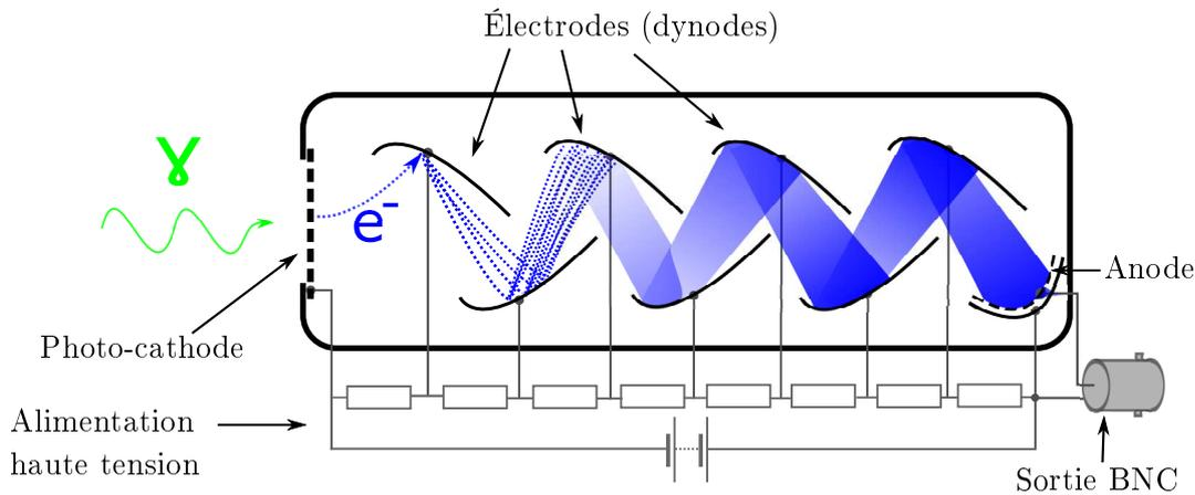
FIGURE 2.7 – Schéma d'un photomultiplicateur à 7 électrodes
