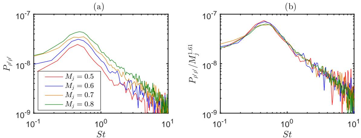
FIGURE 5.10 – Spectres de masse volumique mesurés dans des jets isothermes à  $z = 3D$  au maximum de fluctuations.
