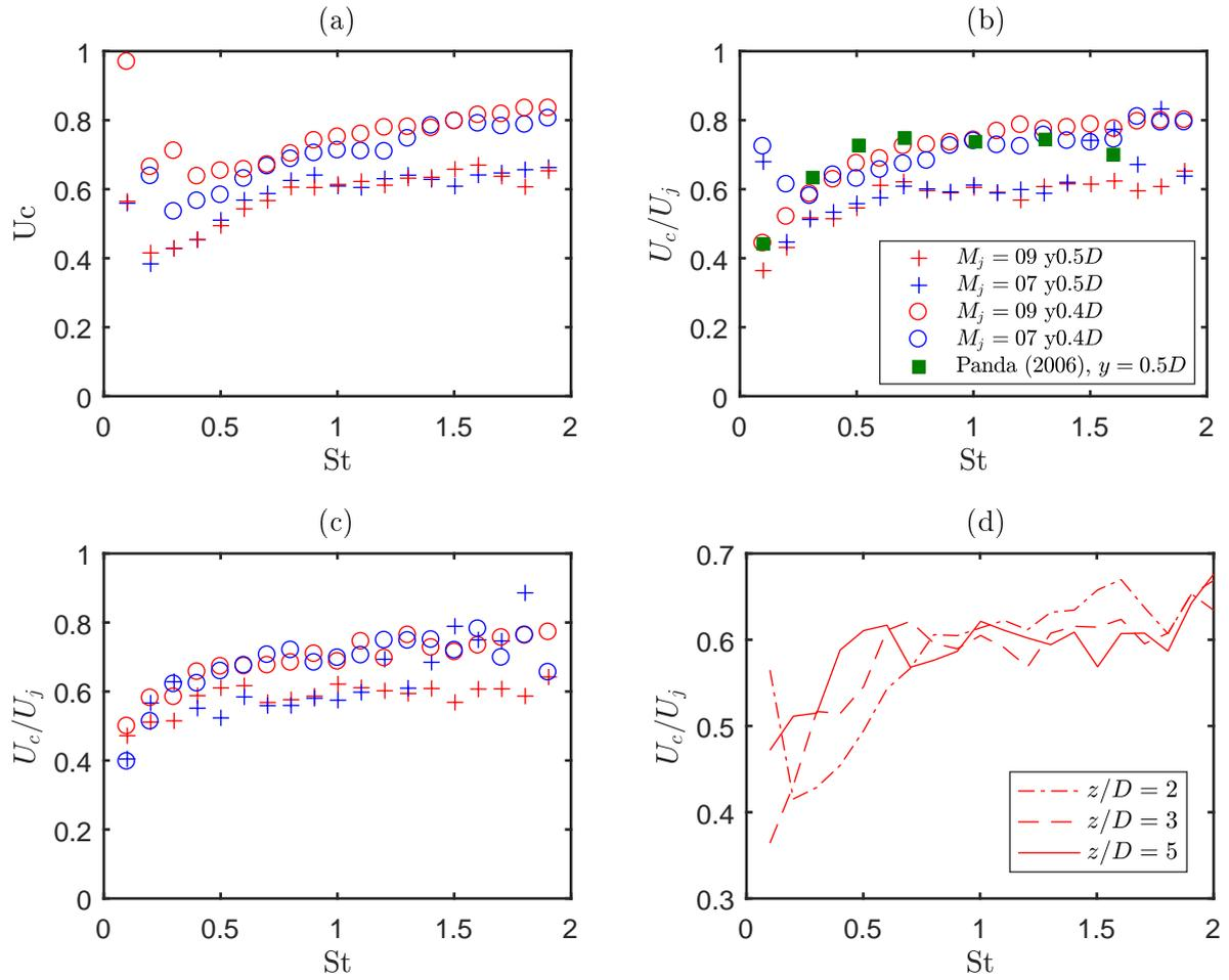
FIGURE 5.19 – (a), (b), (c) : Vitesse de convection mesurée avec  $\Delta z = 0.11D$ , à respectivement  $z/D = 2$ ,  $z/D = 3$ , et  $z/D = 5$ . (d) : Vitesse de convection à  $y/D = 0.5$  pour le jet à  $M_j = 0.9$ .
