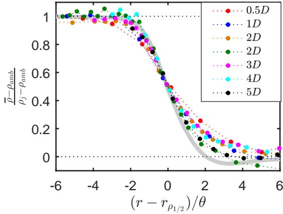
FIGURE 4.10 – Profils radiaux de masse volumique normalisés par l'épaisseur de quantité de mouvement, mesurés dans un jet à Mach 0.9 issu de la tuyère C38. —, d'après Crocco-Busemann
