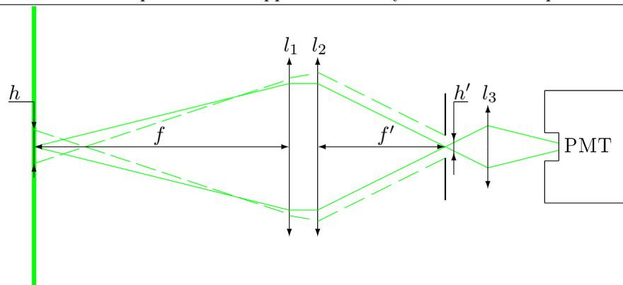
FIGURE 3.13 – Schéma d'un collecteur optique.
