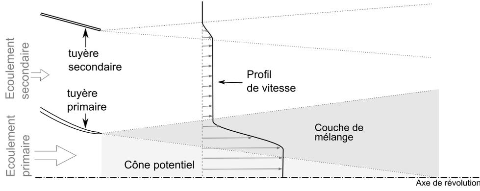
FIGURE 1.1 – Schéma d'un jet rond coaxial.
