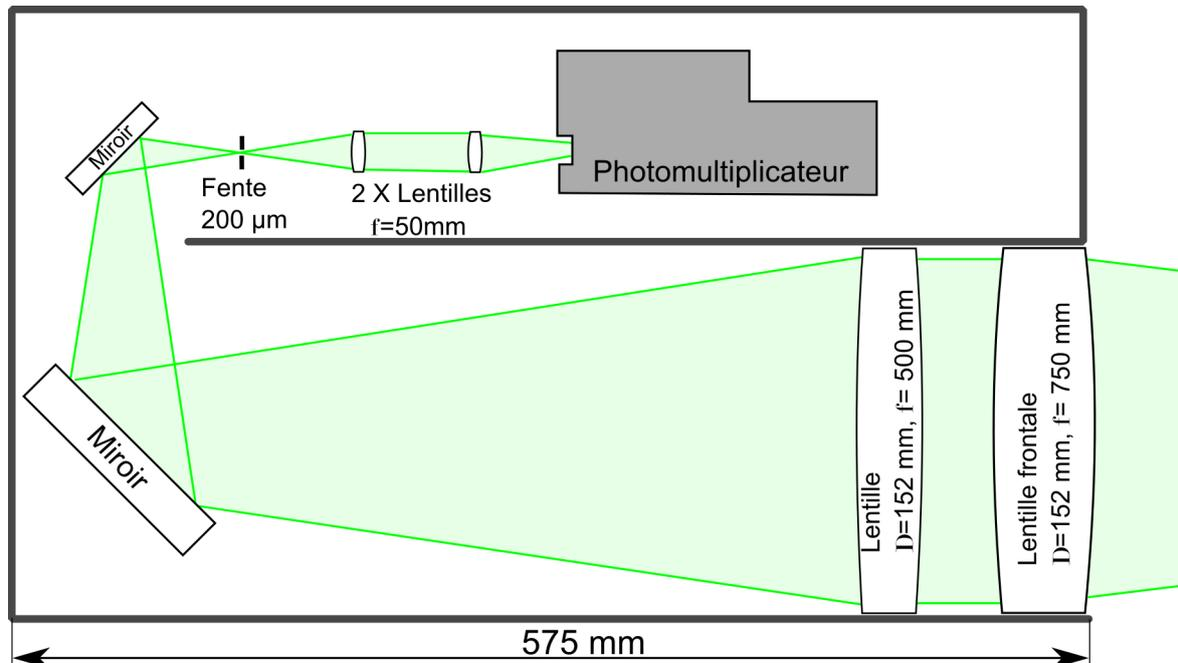
FIGURE 3.4 – Schéma du collecteur 2 à l'échelle.
