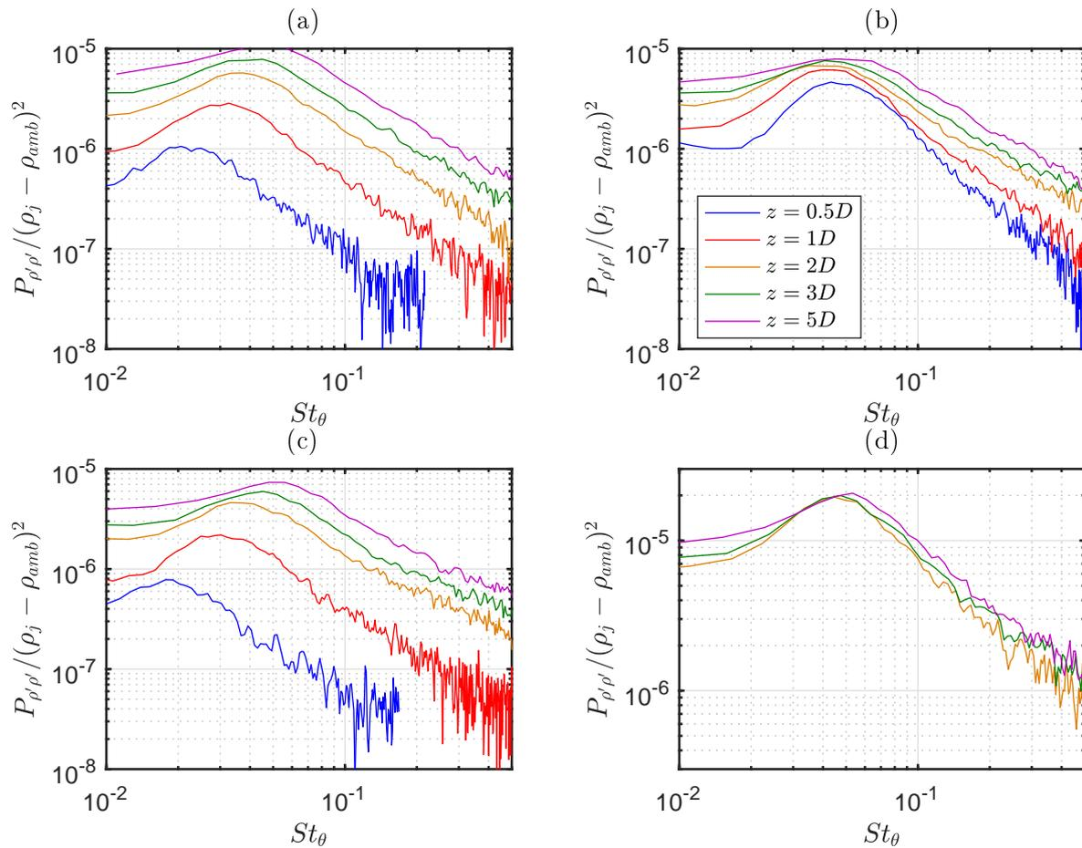
FIGURE 5.4 – Spectres de masse volumique mesurés au pic des fluctuations dans la couche de mélange pour cinq positions axiales. (a)  $M_j = 0.9$  - C38, (b)  $M_j = 0.9$  - ASME, (c)  $M_j = 0.9$  - conique, (d)  $M_j = 0.7$  - C38.
