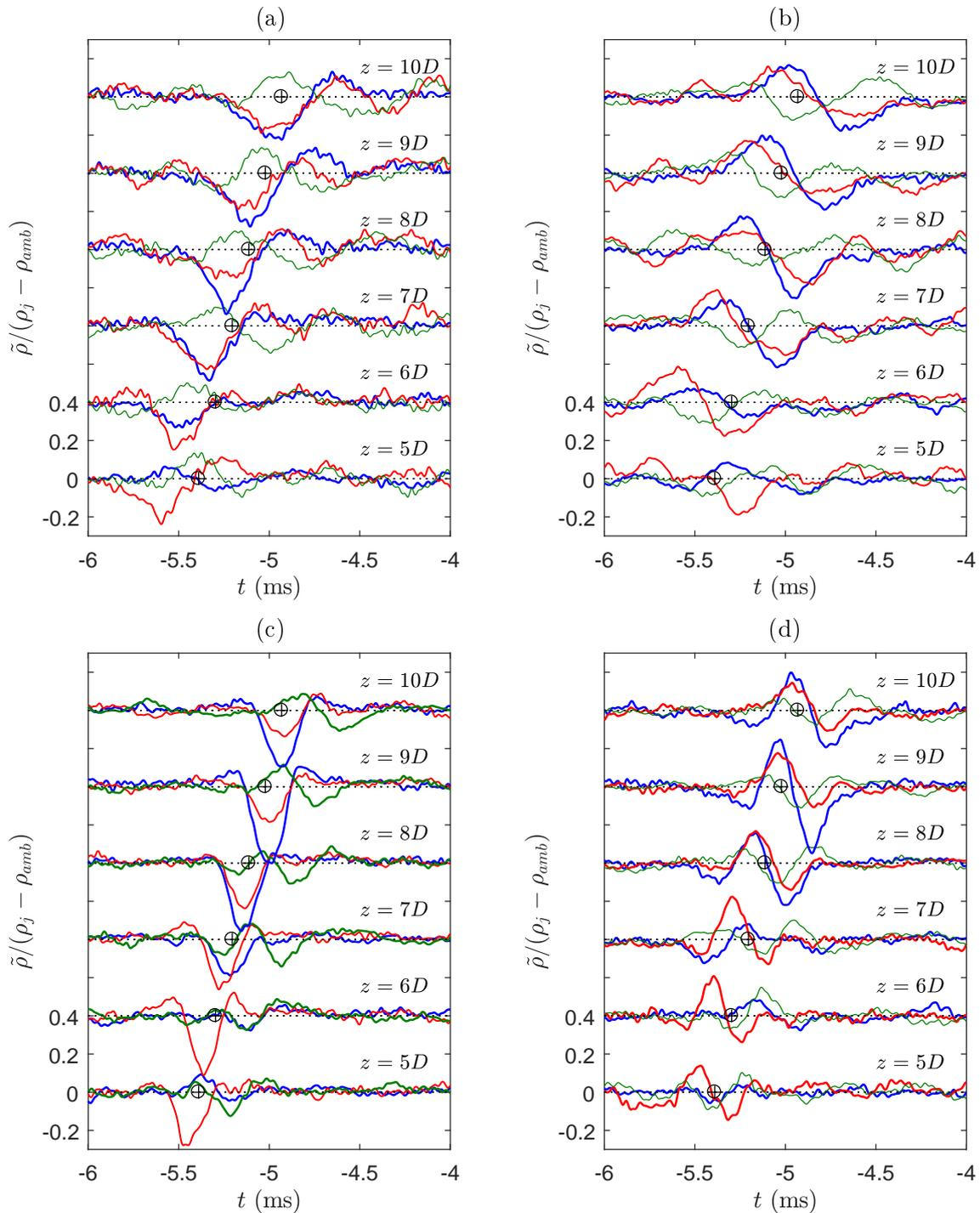
FIGURE 5.33 – Moyennes conditionnées de la masse volumique normalisée à la position radiale indiquée. (a)  $M_j = 0.9$  événements positif, (b)  $M_j = 0.9$  événements négatif, (c)  $M_j = 1.32$  événements positif, (d)  $M_j = 1.32$  événements négatif. —  $y = 0D$ , —  $y = 0.25D$ , —  $y = 0.50D$ .  $\oplus$  temps de propagation en champ libre.
