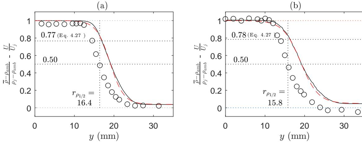
FIGURE 4.13 –  $\circ$ , profil de masse volumique ; —, profil de vitesse ; - - -, profil de vitesse en tangente hyperbolique. Profils à  $z = 2D$  dans un jet froid à Mach 0.9 (a) et 0.7 (b).
