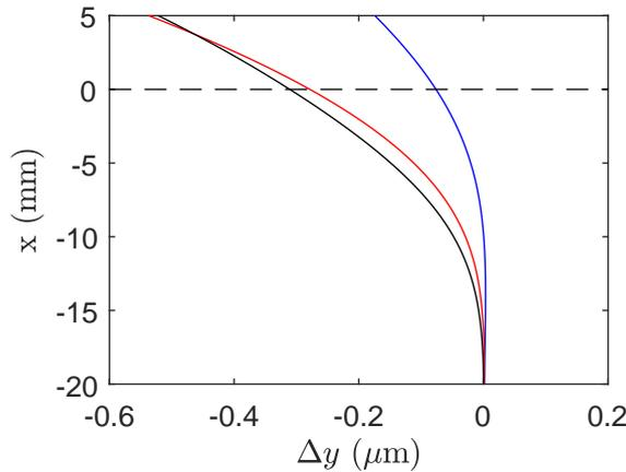
FIGURE 3.17 – Déviation du faisceau suivant la direction  $\vec{y}$  induit par la réfraction dans un jet froid à Mach 0.9. —,  $y = 0.25D$ ; —,  $y = 0.35D$ ; —,  $y = 0.5D$
