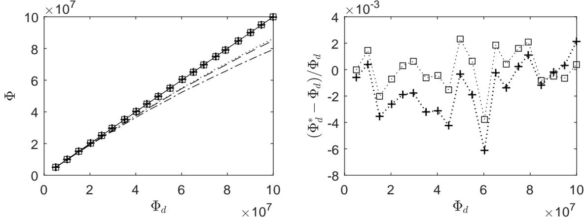
FIGURE 3.12 – A gauche, flux comptés  $\Phi_c$  et corrigés  $\Phi_d^*$  en fonction de  $\Phi_d$  pour des signaux synthétiques. A droite, erreur relative commise pour la correction de  $\Phi_c$  à 1.25 GHz. —,  $\Phi_d$ ; ···,  $\Phi_c$  à 2.5 GHz; ---,  $\Phi_c$  à 1.25 GHz; - · -,  $\Phi_c$  à 0.625 GHz. Flux corrigé  $\Phi_d^*$  à partir de  $\Phi_c$  à 1.25 GHz : □, Eq. (3.3); +, Eq. (3.5).
