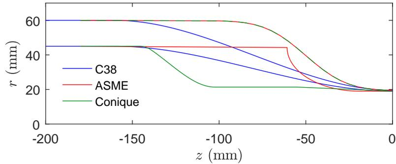
FIGURE 1.8 – Profils intérieurs et extérieurs des trois tuyères convergentes.
