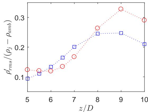
FIGURE 5.24 – Profil axial des fluctuations de masse volumique pour  $M_j = 0.9$  (—), et  $M_j = 1.32$  (—).
