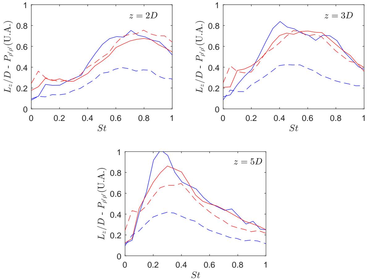
FIGURE 5.17 – Longueurs intégrales  $Lz$  en fonction de la fréquence (—), et spectres des fluctuations  $P_{\rho'\rho'}$  (---) aux positions indiquées. Les spectres sont normalisés par une valeur arbitraire. —,  $M_j = 0.7$ ; —,  $M_j = 0.9$
