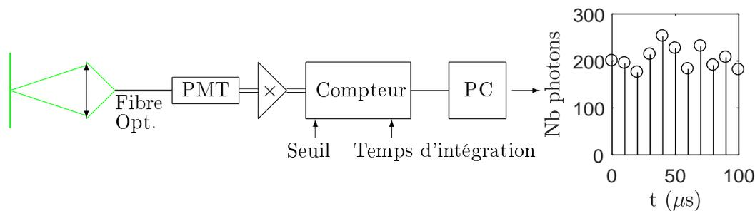
FIGURE 3.5 – Schéma d'une chaîne d'acquisition classique
