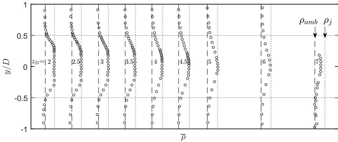
FIGURE 4.5 – Profils radiaux de masse volumique mesurés dans un jet à Mach 0.7 issu de la tuyère C38. En moyenne  $\rho_{amb} = 1.18 \text{ kg/m}^3$  et  $\rho_j = 1.25 \text{ kg/m}^3$
