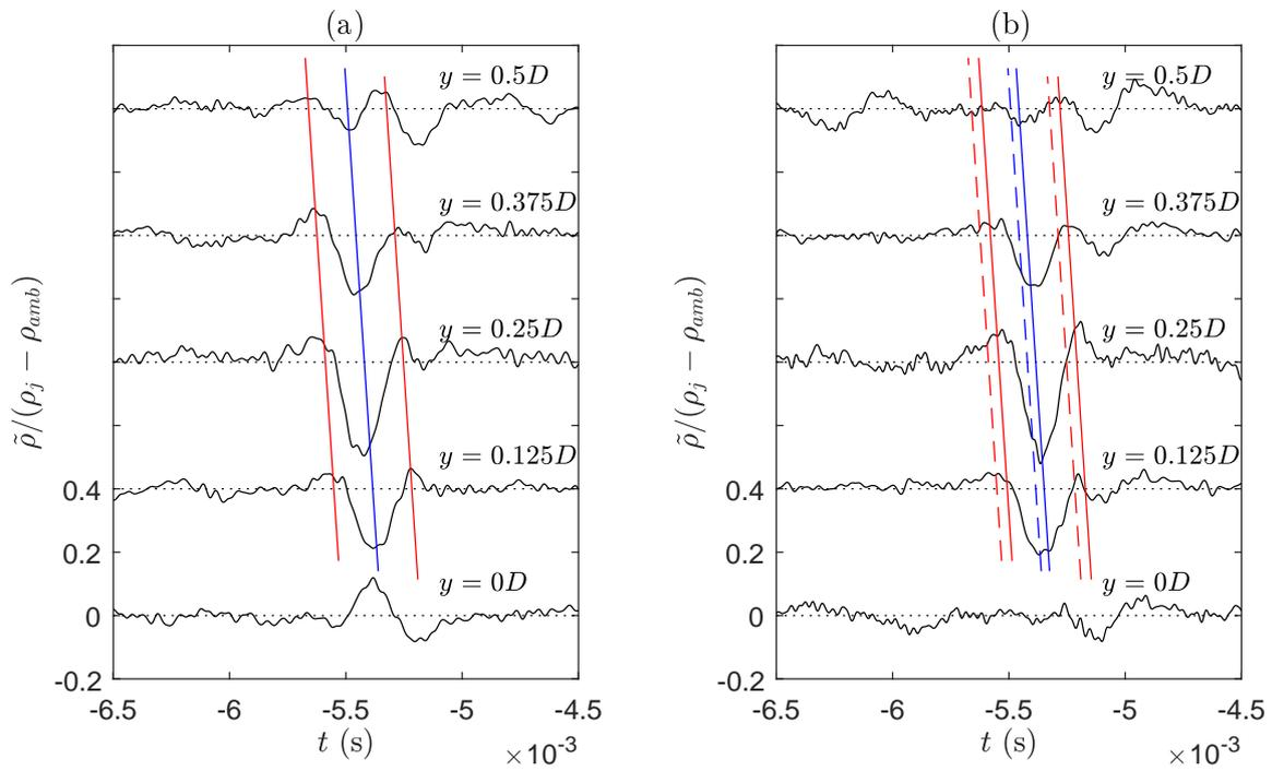
FIGURE 5.34 – Moyennes conditionnées de la masse volumique normalisée à la position radiale indiquée, basé sur l’acoustique à  $30^\circ$  du jet à  $M_j = 1.32$ . (a)  $z = 5.5D$ , (b)  $z = 6.0D$ . Les pointillés (b) correspondent aux lignes en (a).
