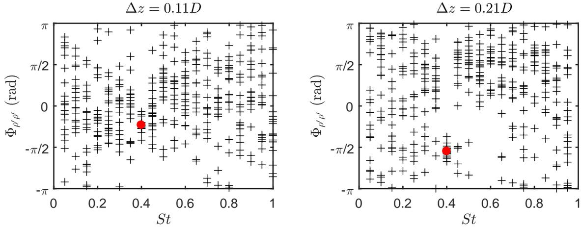
FIGURE 5.21 – Phase de l'interspectre entre deux signaux de masse volumique mesurés en deux points centrés sur  $y = 0D$  et  $z = 3D$ .
