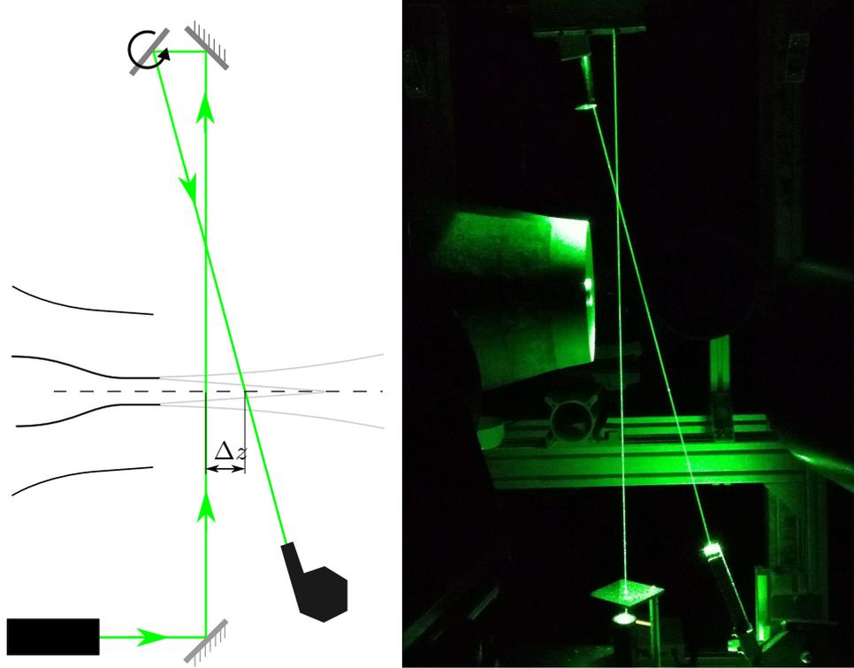
FIGURE 5.12 – Schéma (gauche) et illustration (droite) du dispositif permettant la mesure de masse volumique en deux points.
