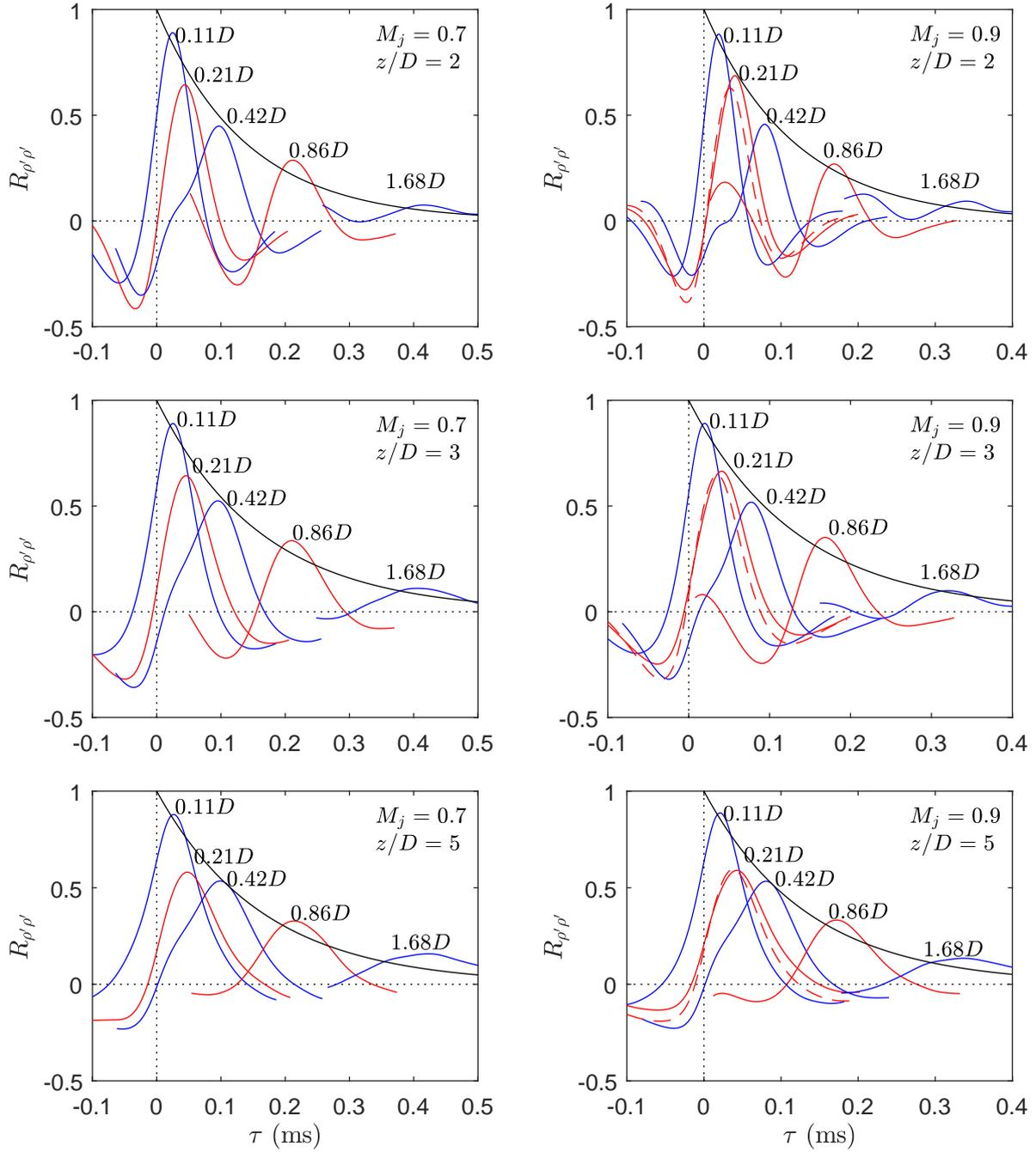
FIGURE 5.13 – Fonctions d’inter-corrélation pour  $M_j = 0.7$  (gauche) et  $M_j = 0.9$  (droite) en différentes positions axiale et à la position radiale  $y/D = 0.4$ . Les pointillés illustrent les résultats issus de mesures complémentaires pour  $\Delta z = 0.21$  et  $M_j = 0.9$ .
