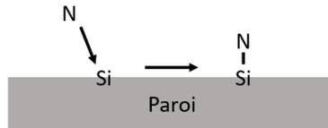
Figure II.5 : Illustration du piégeage des radicaux d'azote aux parois par effet getter.
