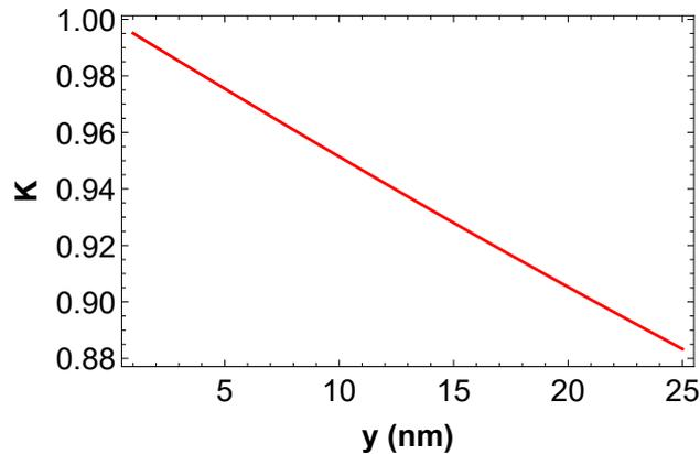
FIGURE III.7 – Graphe théorique donnant le coefficient multiplicateur sur le coefficient  $C_3$  attribué à l'effet de retard.
