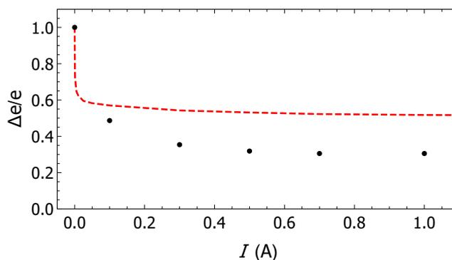
FIGURE II.20 – Fraction d'atomes traversants le dispositif en fonction du champ magnétique statique. La largeur du canal non affecté par l'effet de gradient est donnée par  $\Delta e$ . La transmission expérimentale (points noirs) atteint un plateau à environ 30 % de la largeur d'entrefer,  $e$ . Le calcul est représenté en trait rouge hachuré.
