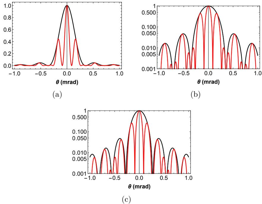
FIGURE III.3 – Intensité transmise au travers d’un nanoréseau d’ouverture  $e = 50$  nm et de pas  $a = 100$  nm (a) en échelle linéaire et (b) logarithmique et (c) l’intensité transmise au travers d’un nanoréseau d’ouverture  $e = 65$  nm et de pas  $a = 100$  nm en échelle logarithmique. Courbe noire, diffraction à une fente ; courbe rouge, diffraction à deux fentes.
