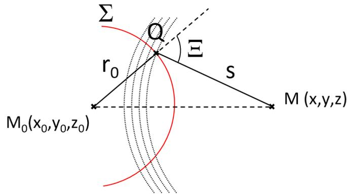
FIGURE III.1 – Construction géométrique pour le calcul de l'amplitude du champ en un point  $M$  comme une interférence de l'ensemble des sources secondaires  $Q$ . cf. BORN and WOLF [59].
