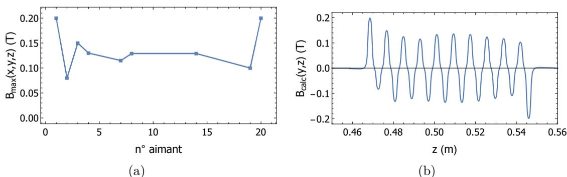
FIGURE II.16 – (a) Points de mesure à  $B_{max}$  (*i.e.* courant de 10 A) relevés par Bouhnik®. La constante de temps vaut dans ce cas 50  $\mu$ s. Les variations temporelles du champ ont été mesurées à l'aide d'une sonde à effet Hall. (b) Allure théorique du champ magnétique statique dont le calcul est présenté en annexe E.
