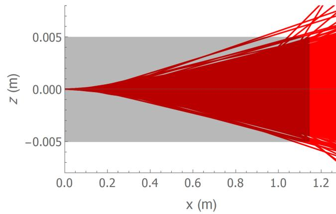
FIGURE B.2 – Imagerie à deux dimensions du jet supersonique pour une vitesse finale théorique minimale réalisée à partir de 1000 trajectoires générées aléatoirement :  $v_x = 15 \text{ m.s}^{-1}$  (1,1 A),  $\delta_L = -340 \text{ MHz}$ ,  $P_{opt} = 30 \text{ mW}$ . Le rectangle transparent représente la géométrie du tube intérieur (sous vide) du ralentisseur de 10 mm de diamètre.
