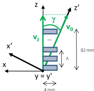
FIGURE II.10 – Schéma de la géométrie du dispositif. Le jet direct arrive sous un angle d'incidence  $\gamma$  le long de l'axe  $z'$ . Nous sommes contraint, par la présence de la gravité, d'envoyer les atomes d' $\text{Ar}^*$  à plus de  $50 \text{ m.s}^{-1}$ . A ces vitesses, des décalages en temps de vol et en position sont observables expérimentalement.
