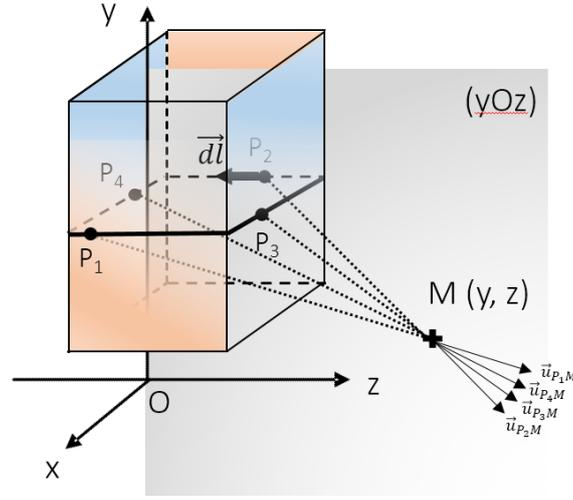
FIGURE E.3 – Schéma d'un barreau aimanté. La détermination de la configuration du champ magnétique statique se fait dans le plan  $(yOz)$ . Le calcul consiste à intégrer un élément de parcours du courant placé en  $P_i$  qui crée le champ élémentaire  $d\vec{B}$  en un point M du plan. En orange, les petits côtés ; en bleu, les grands côtés.
