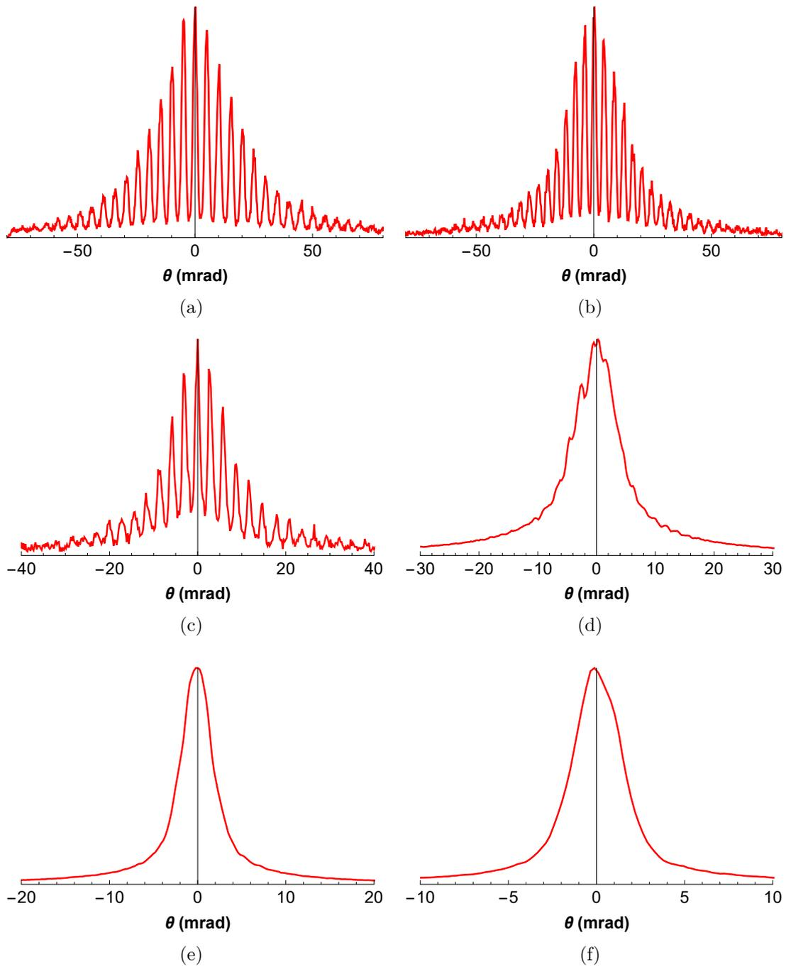
FIGURE III.9 – Profils de diffraction expérimentaux selon l'axe vertical  $y$  pour plusieurs vitesses. Les profils sont normalisés à 1. (a) 20 m.s<sup>-1</sup>, (b) 25 m.s<sup>-1</sup>, (c) 35 m.s<sup>-1</sup>, (d) 50 m.s<sup>-1</sup>, (e) 100 m.s<sup>-1</sup> et (f) 150 m.s<sup>-1</sup>. Il est à noter que l'échelle des abscisses se réduit au fur et à mesure que la vitesse augmente.
