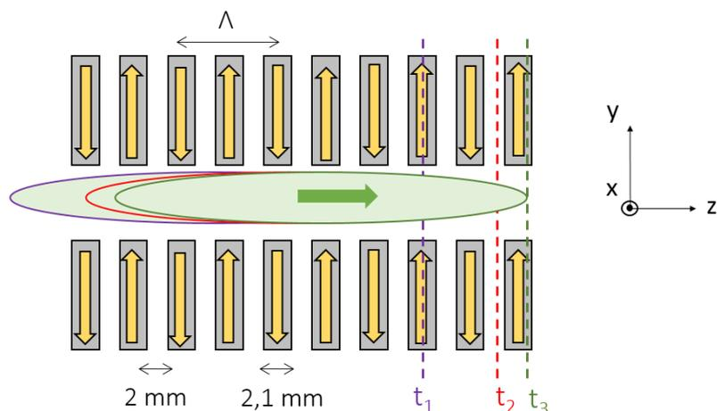
FIGURE II.9 – Représentation schématique de trois positions du nuage (violet, rouge et vert) lors de trois temps de déclenchement différents,  $t_1$ ,  $t_2$  et  $t_3$  dans le générateur de période spatiale  $\Lambda = 8,1$  mm. Le changement de vitesse s'opère pour des atomes situés à la fin du générateur de sorte qu'ils n'aient à parcourir qu'une période au maximum (environ deux électroaimants).
