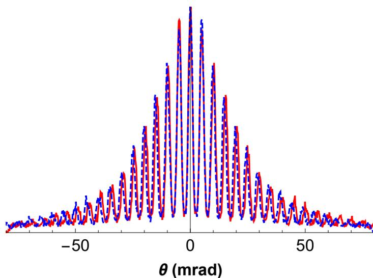
FIGURE III.31 – Repliement (courbe hachurée bleue) du profil d'intensité diffractée (courbe rouge) pour une classe de vitesse atomique dont la valeur moyenne est de  $20 \text{ m.s}^{-1}$ . Les profils ont été artificiellement centrés en 0.
