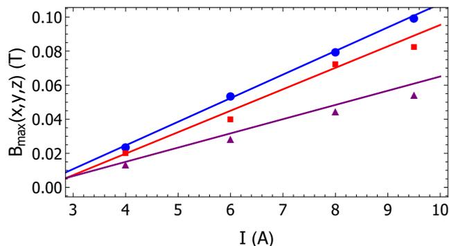
FIGURE II.17 – Champ magnétique du dispositif co-mobile en fonction du courant pour différentes constantes de temps : 50  $\mu s$  (points bleus), 200  $\mu s$  (carrés rouges) et 500  $\mu s$  (triangles violets). Mesure réalisée par Bouhnik® à l'aide d'un capteur à effet Hall au niveau de l'électroaimant 19.
