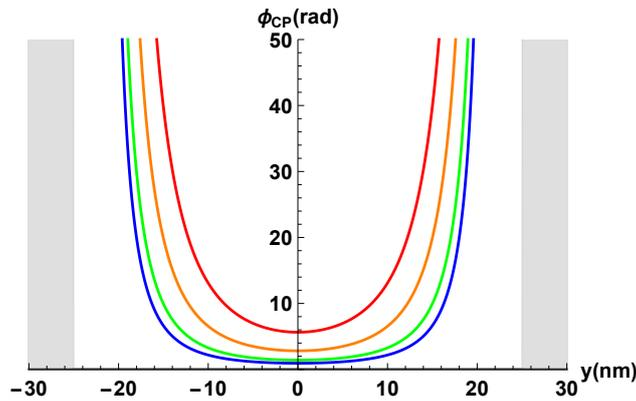
FIGURE III.13 – Déphasage théorique  $\phi_{CP}(y)$  de l'onde atomique en  $z = L = 110$  nm en fonction de la position dans l'ouverture du réseau selon  $y$  avec  $C_3 = 8,99$  meV.nm<sup>-3</sup>. L'atome est à la vitesse de 25, 50, 100 et 150 m.s<sup>-1</sup> (courbes rouge, orange, verte et bleue respectivement). Les surfaces des fentes sont représentées par les zones grisées.
