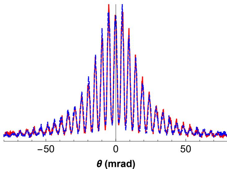
FIGURE III.32 – Repliement (courbe hachurée bleue) du profil d'intensité diffractée (courbe rouge) pour une classe de vitesse atomique dont la valeur moyenne est de  $20 \text{ m.s}^{-1}$ . Lorsque les fentes du réseau sont placées verticalement (*i.e.* figure de diffraction à l'horizontale) le profil de diffraction à deux fentes ne manifeste pas de différence d'interfrange entre le haut et le bas du détecteur. L'interfrange est constant.
