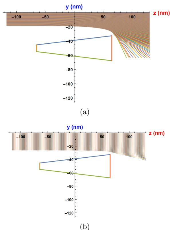
FIGURE III.14 – Calcul des trajectoires  $y(z)$  pour des atomes à (a)  $20 \text{ m.s}^{-1}$  et (b)  $100 \text{ m.s}^{-1}$ , en l'absence de gravité. A  $20 \text{ m.s}^{-1}$ , la modifications des trajectoires atomiques est notable : en sortie de réseau, le calcul donne plusieurs radians de déviation.
