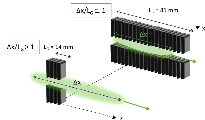
FIGURE II.32 – Schéma illustrant les deux expériences citées pour deux configurations du dispositif. La longueur  $L_G$  du générateur est soit plus grande que l'étendue spatiale du nuage atomique, soit plus petite.
