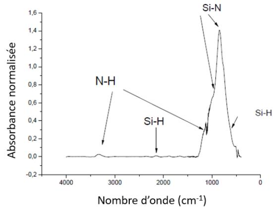
FIGURE III.6 – Spectre d’absorption du  $\text{Si}_3\text{N}_4$  qui donne l’absorbance du matériau en fonction de l’énergie incidente en  $\text{cm}^{-1}$ .
