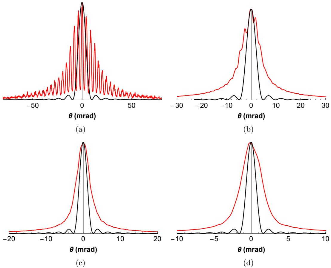
FIGURE III.10 – Profils de diffraction « optique » (courbe noire) et expérimentale (courbe rouge) selon l'axe vertical  $y$  pour des atomes à vitesse moyenne de (a)  $25 \text{ m.s}^{-1}$ , (b)  $50 \text{ m.s}^{-1}$ , (c)  $100 \text{ m.s}^{-1}$  et (d)  $150 \text{ m.s}^{-1}$ .
