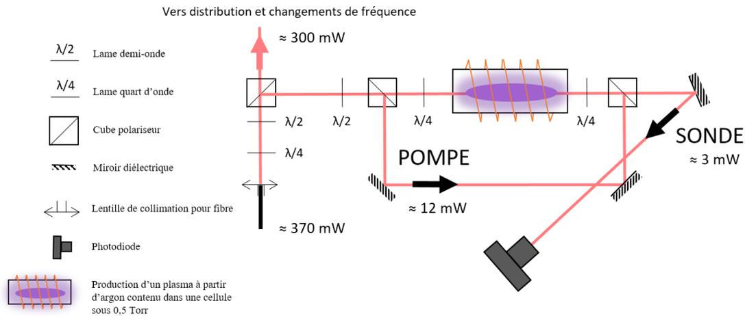
FIGURE I.13 – Schéma de principe du dispositif optique pour l'asservissement en fréquence de la diode laser. Après le passage du faisceau au travers des divers outils optiques (lames, cubes, *etc.*), la puissance utile au montage d'absorption saturée est de 15 mW environ.
