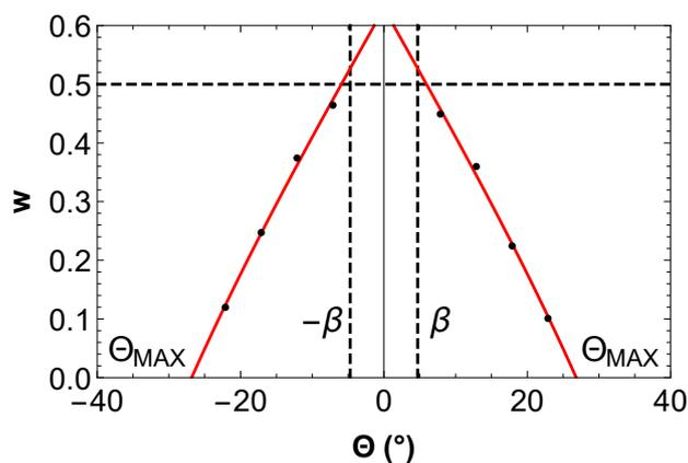
FIGURE III.20 – Courbe de transmission théorique (en trait rouge plein) et points expérimentaux pour une vitesse de  $560 \text{ m.s}^{-1}$ . Pour le calcul  $e = 53 \text{ nm}$  : on trouve alors  $L = 132 \text{ nm}$  et  $\beta = 6^\circ$ .
