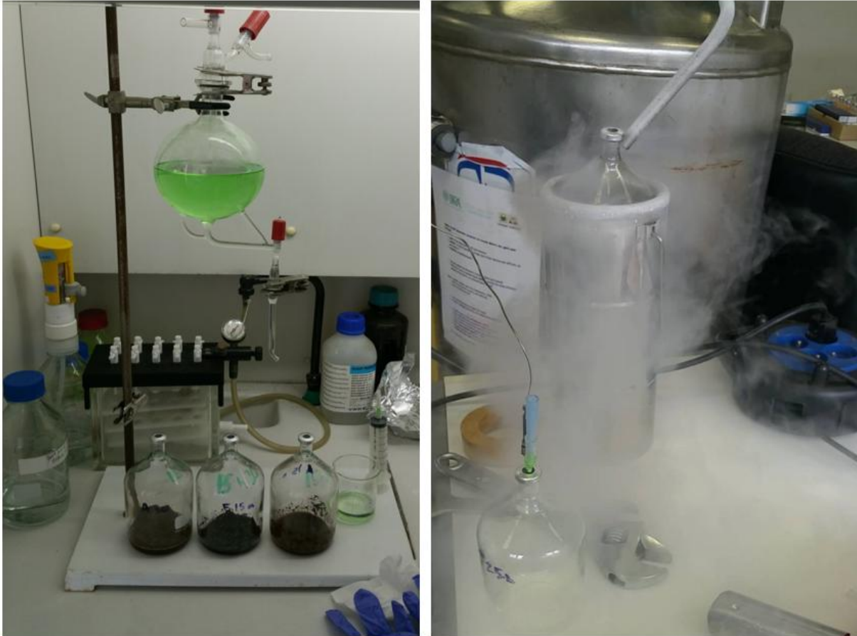
Photo T 5 & 6. Aperçu d'une étape d'acidification des sols et d'une étape de cristallisation du CO 2 , lors de tests expérimentaux réalisés dans le but de mesurer la teneur en carbonates dans les sols ainsi que leur isotopie.
