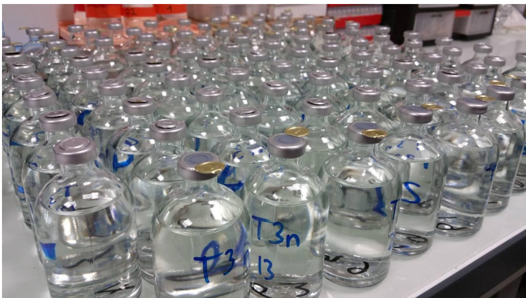
Photo T10 fioles de prélèvement de DIC-DI ^{13}\text{C} en attente d'analyses au spectromètre de masse
