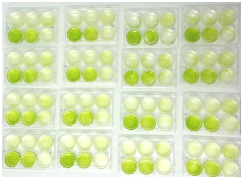
Fig. T19 Plaques 6 puits pour tester la limitation des algues dans les différents traitements
