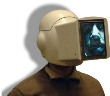
Figure 19 Interstitial Space Helmet (Auger, 2004), casque de réalité virtuelle qui permet de se projeter dans une autre réalité tout en affi- chant l'image de son avatar sur le casque.
