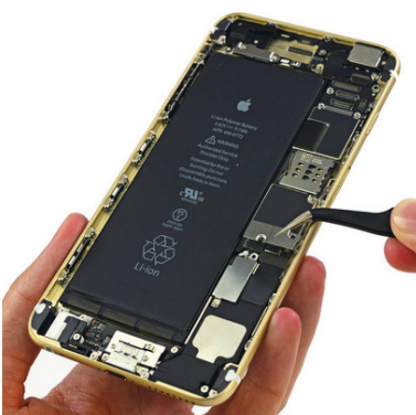
Figure 52 Emplacement de l'accéléromètre contenu dans un iPhone 6S de la marque Apple.
