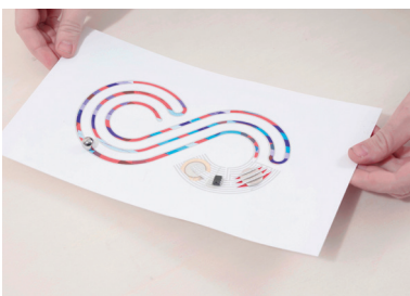
Figure 15 Papier Machine (Pluvinage & Pinaffo, 2018), cahier graphique de jeux électroniques en papier prédécoupé permettant de fabriquer des systèmes électroniques simples, avec du papier et de l'encre conductrice.
