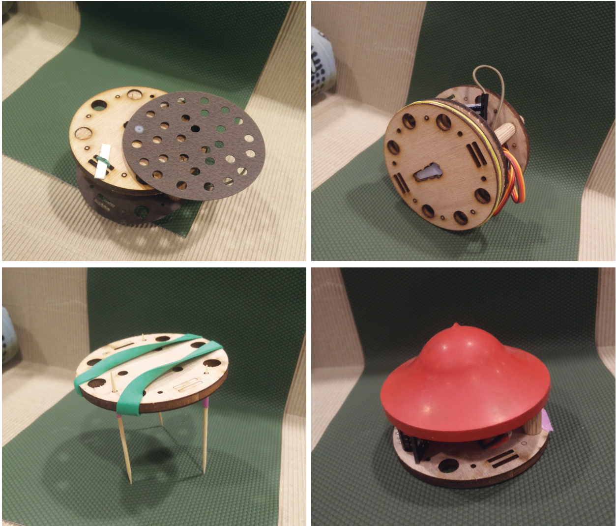
Figure 56 Prototypage des différents modules qui proposent une action par capteur, tourner pour le gyroscope, se déplacer pour l'accéléromètre, vibrer pour le capteur de proximité et s'allumer pour le capteur de luminosité.
