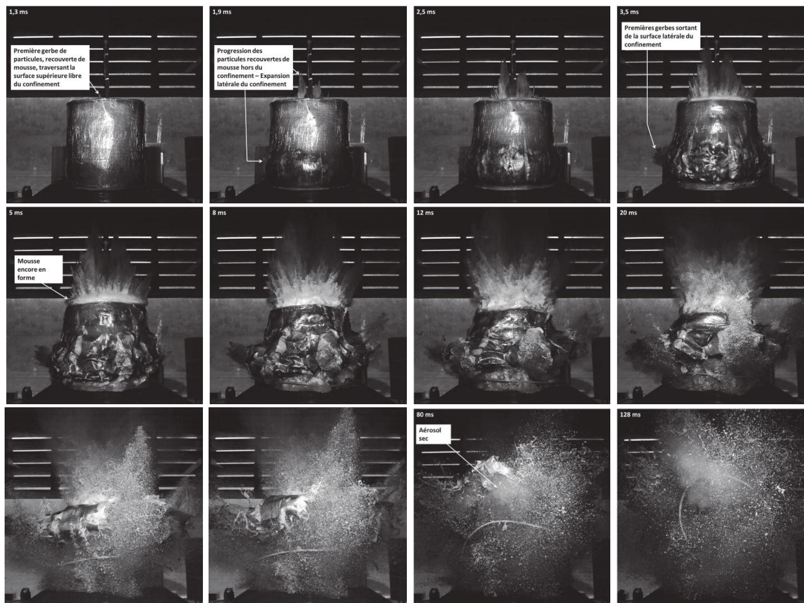
Figure 7.20 – Évolution de l'onde de souffle, des produits de détonation et des particules, dans l'air, observée lors de l'essai 100-P 3 -88-PC (champ optique : 1024 x 1024 mm 2 )
