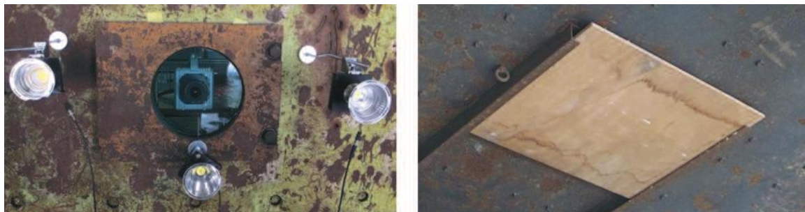
Figure 7.8 – À gauche : système de visualisation avec la caméra ultra-rapide au centre, et trois éclairages leds. À droite : vue de la plaque en bois fixée au plafond.
