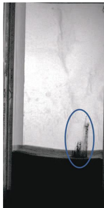
(d) sortie des particules pour h_m = 20 cm
