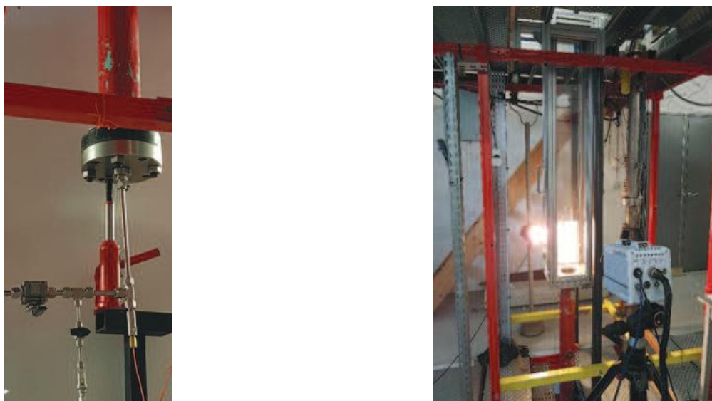
Figure 5.17 – Photographie du dispositif tube à détonation : système d'injection du gaz dans le booster et d'amorçage (à gauche) et enceinte transparente recevant la mousse (à droite) avec le projecteur halogène et la caméra pour l'enregistrement du phénomène.
