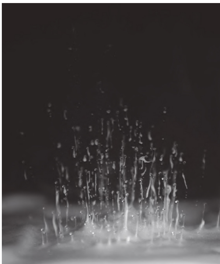
Figure 4.7 – Photographie de la sortie de billes de verre de la surface libre de la mousse
