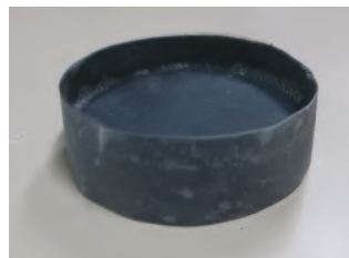
Figure 7.11 – État de l'étui en carton après avoir été immergé 30 minutes dans un récipient rempli de mousse
