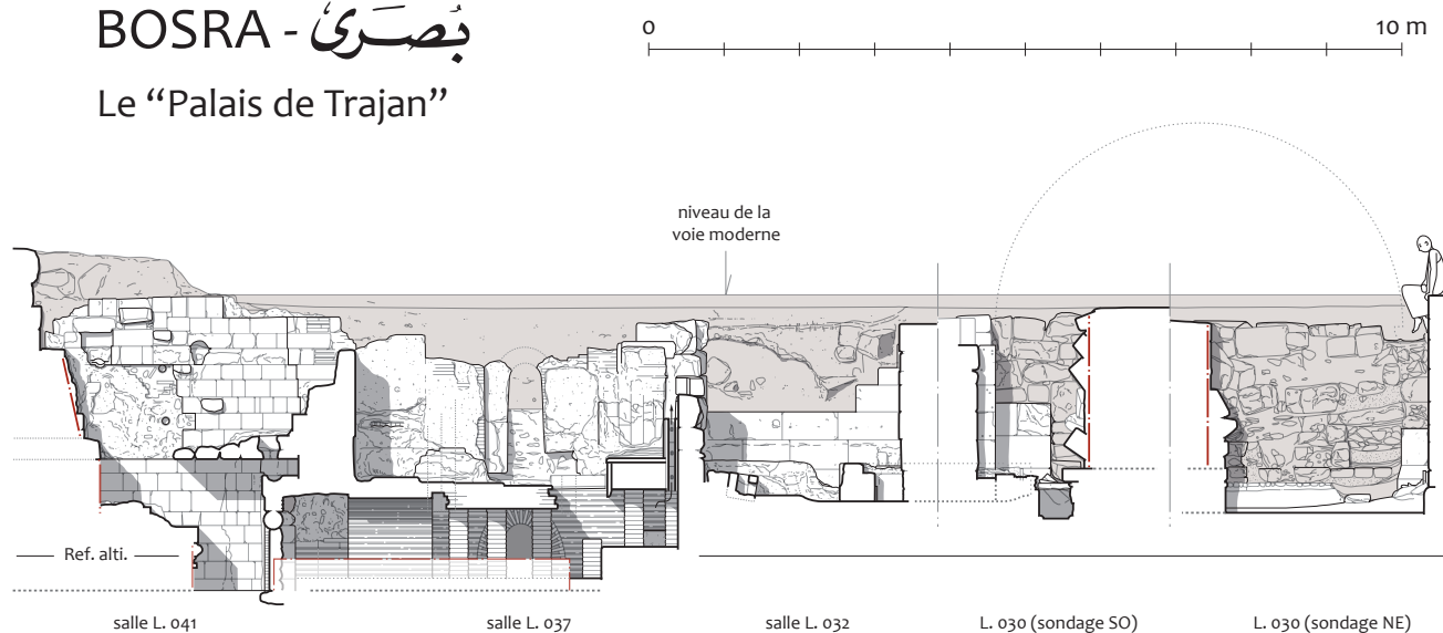
Fig. 36. Le «Palais de Trajan», coupe 7, coupe-élévation nord-sud, vers l'ouest, sur les salles 41, 37, 32 et 30 des bains (1/100 e )
