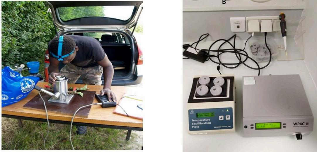
Figure 3 : mesures de potentiel hydrique minimal des feuilles (A) et mesures de potentiel hydrique des fruits (B).
