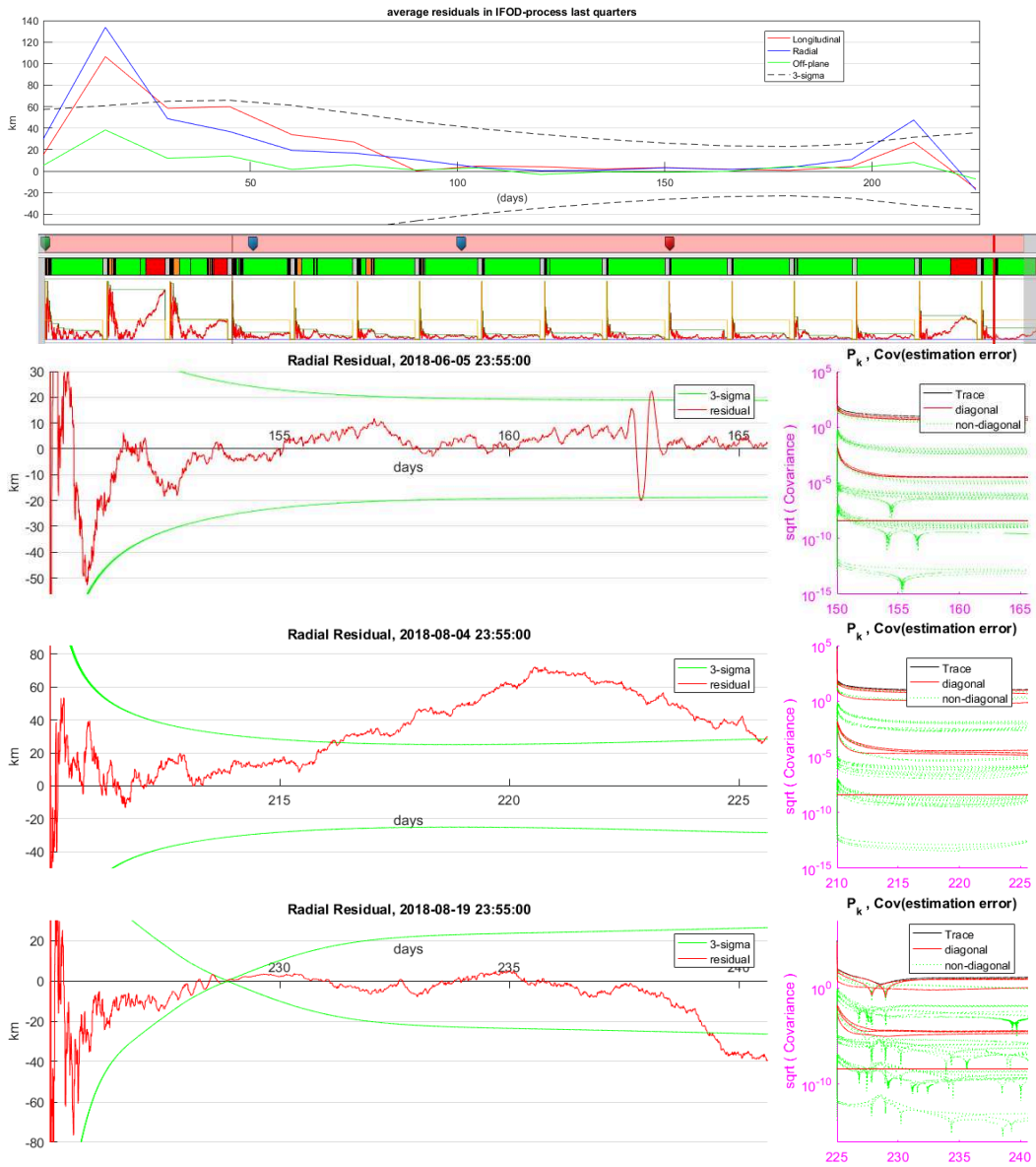
FIGURE 6.8 – Série UKF-5FGB. Haut : synthèse sur tout le scénario de vol. Milieu et bas : détails du filtrage aux dates 150, 210 et 225, Résidu majorant (à gauche), évolution de la covariance (à droite). Remarque : au jour \sim 228 , l'enveloppe 3\sigma se resserre jusqu'à environ \pm 500 m ! Pour mémoire, \sigma_{opt} = 0.2'' .
