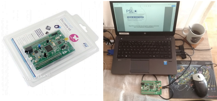
FIGURE 7.1 – Carte ST Micro STM32F407, connectée par simple câble USB.
