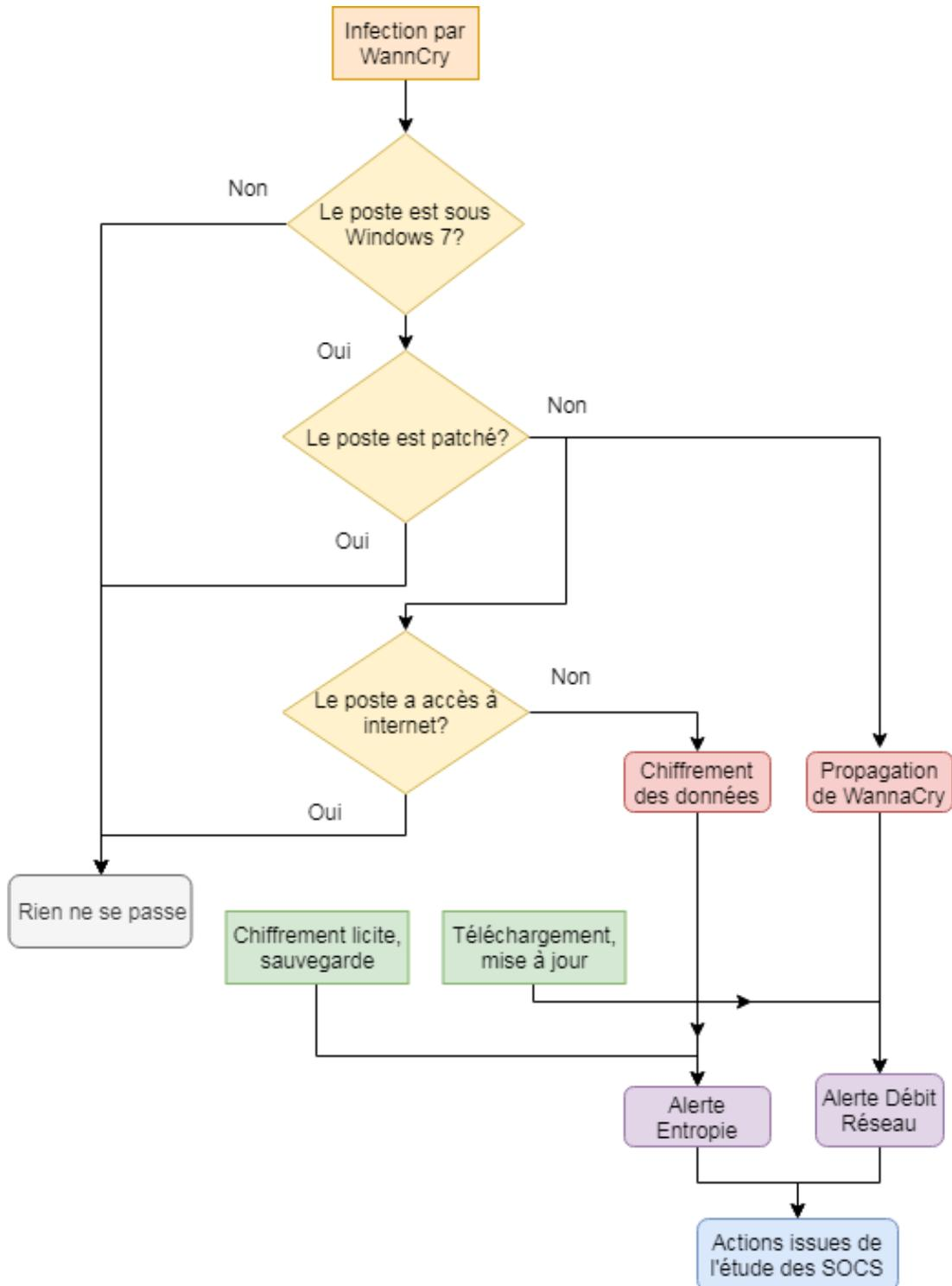
FIGURE 3.10 – Proposition de modélisation du rançongiciel WannaCry. L'infection d'un poste lève des alertes relatives à l'entropie ou au débit réseau. Ces alertes devront être traitées par les analystes, qui auront aussi affaire à des alertes déclenchées par des actions licites (faux positifs).
