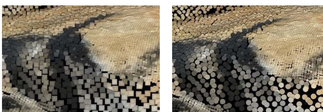
Figure 143 : Rendu des points sous forme de carrés ou de cercles par Potree.JS.
