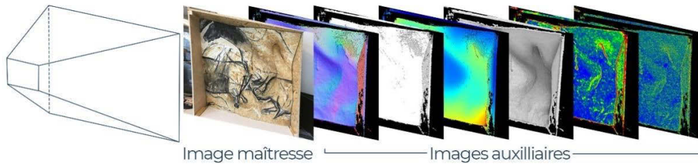
Figure 107 : Modèle de caméra permettant de prendre en compte des images de caractérisation géométrique. Illustration : auteur.
