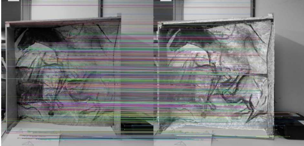
Figure 160 : Comparaison des deux images par SURF et FLANN. La distance entre chaque paire de points homologues donne une indication concernant l'écart du nuage de points à sa position réelle.
