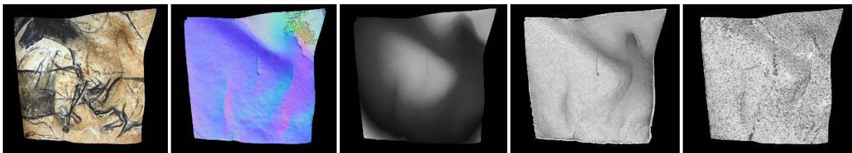
Figure 39 : Exemples de cartes de texture caractérisant des attributs géométriques ou visuels de l'objet d'étude. De gauche à droite : couleurs, normales, profondeur, occlusion ambiante, rugosité.
