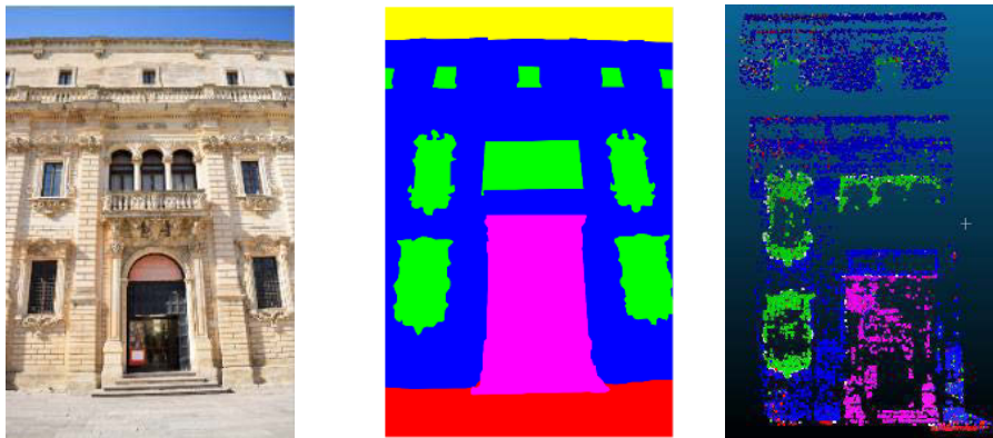
Figure 49 : Résultats expérimentaux de l'approche proposée par Stathopoulou et Remondino (2019). Gauche : Image originale. Centre : Image segmentée sémantiquement. Droite : Nuage de points épars après transfert des labels. Illustration : (Stathopoulou, Remondino, 2019).
