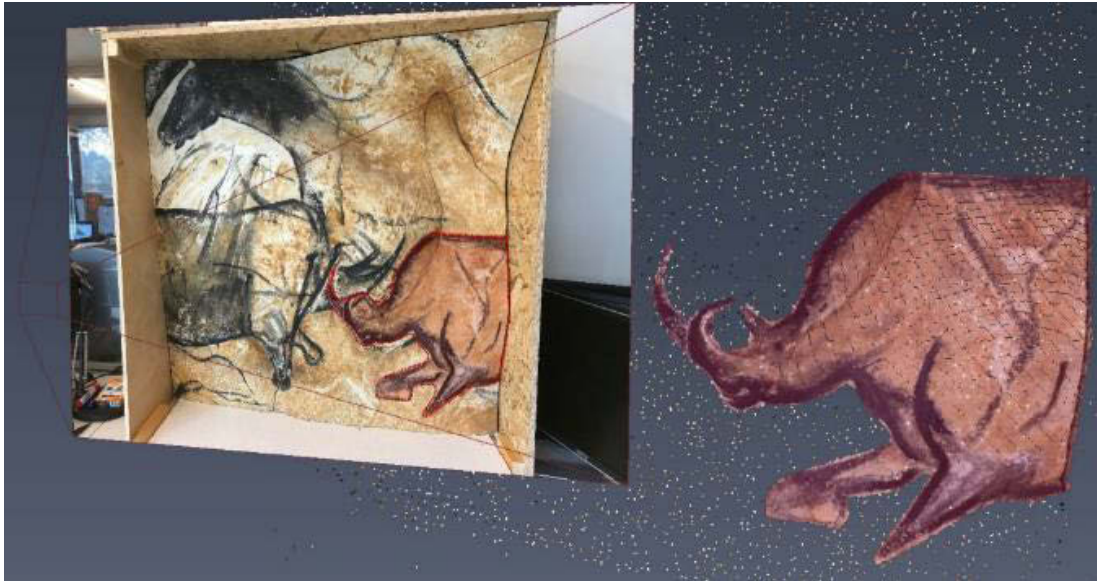
Figure 132 : Adaptation de la couleur et de l'opacité d'une région 3D pour l'harmonisation des matériaux d'annotation 2D et 3D. La prise en charge des propriétés de contours et des textures de remplissage est plus complexe.
