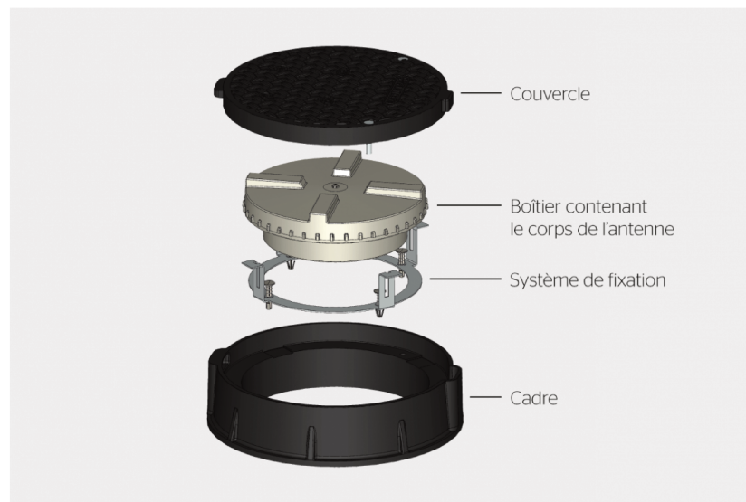
FIGURE 1.3 – Exemple d'antenne de la société Katherein pour une petite cellule intégrée à une plaque d'égout [42].
