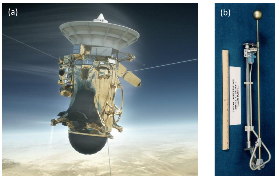
Figure 11 : (a) Position de la sonde de Langmuir sur la sonde Cassini. Crédits : NASA. (b) Sonde de Langmuir de Cassini, repliée. Crédits : IRF.
