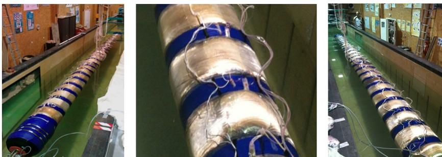
FIGURE 5.1 – Photos de la maquette avec les bagues de polymères électro-actif
