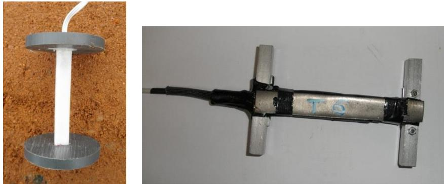
Figure 2.4. Jauge de déformation verticale (a) et jauge de déformation horizontale (b) (longitudinale ou transversale)
