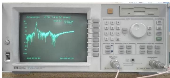
Figure 2.11 : Photographie de l'analyseur de réseau de type HP8711C
