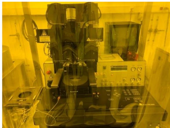
**Figure 2.6** : Photographie de l'aligneur de masques MA6/BA6
