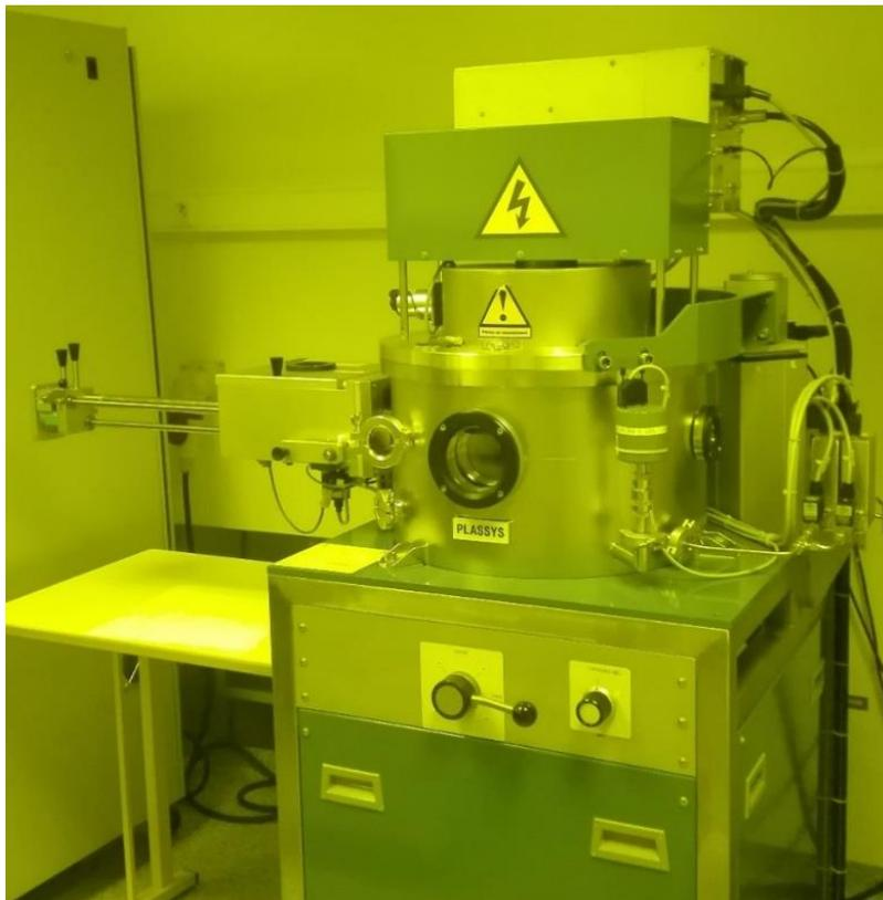
**Figure 2.3 :** Photo du bâti de pulvérisation cathodique MP 450S
