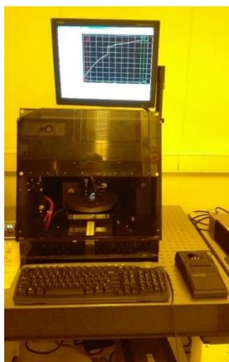
**Figure 2.9 :** Photographie du profilomètre Dektak 8
