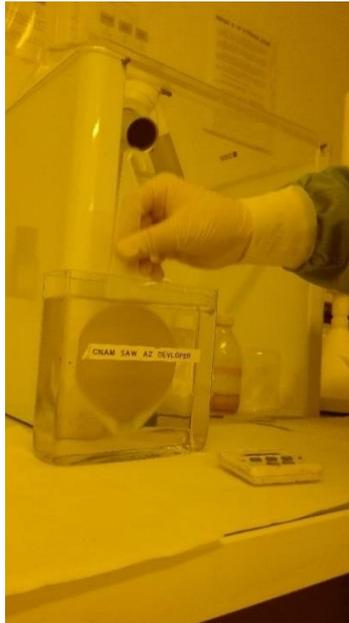
**Figure 2.16 :** Développement de la résine
