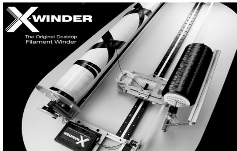
FIGURE 2.3 – Principe de l'enroulement filamentaire de fibres pré-imprégnées [3DP]
