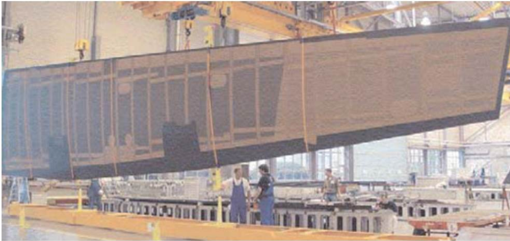
FIGURE 1.1 – Aile de l’A400M de 23 mètres de longueur et 3 tonnes [UIM, 2007]
