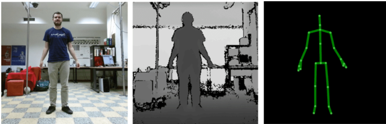
FIGURE 63 – Exemple de données provenant de capteurs RGB-D comme la Kinect 2 de Microsoft : à gauche on trouve une image 2D en couleurs, une image de profondeur au milieu et le squelette 3D à droite (Cliché M. Devanne).
