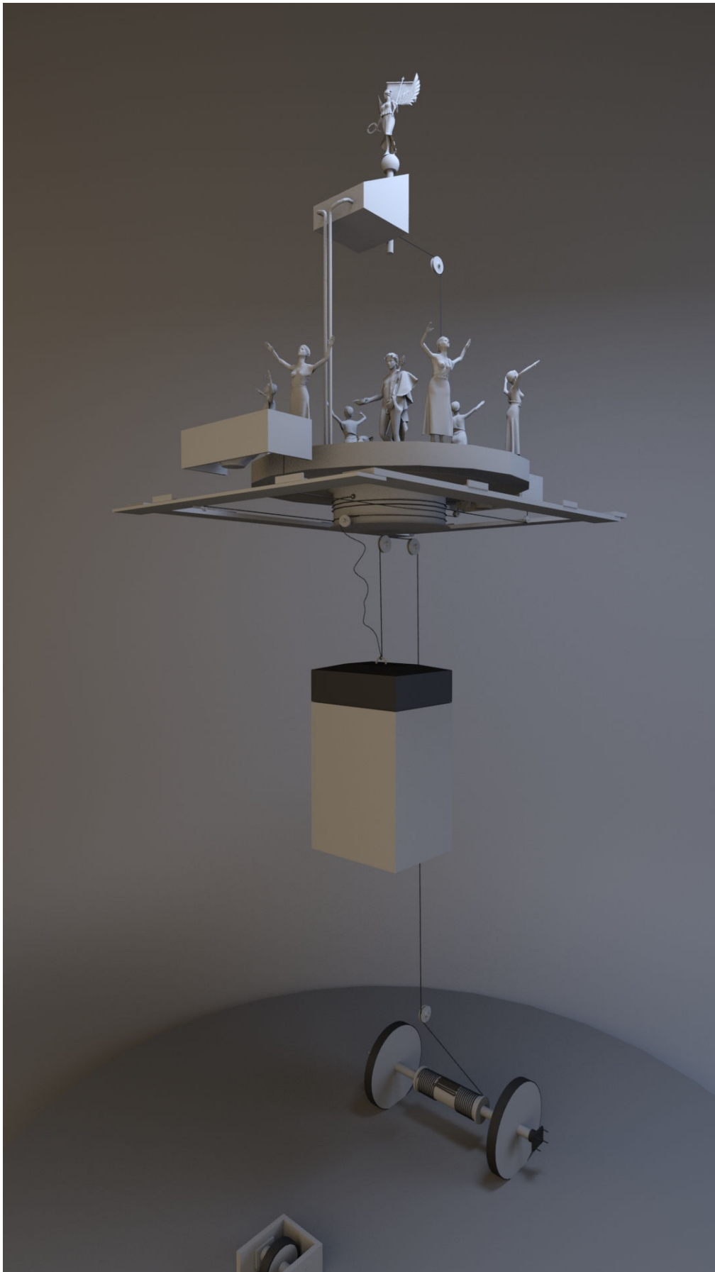
FIGURE 56 – Vue générale du mécanisme interne du théâtre automatique à base mobile d'Héron d'Alexandrie (Réalisation J. Nicolle).
