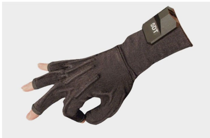
FIGURE 67 – Gant de données 5dt Glove
