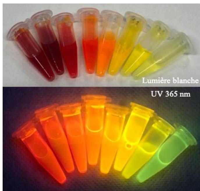
Figure 3.6 : Les 8 fractions sous lumière blanche en haut et sous une excitation UV à 365 nm en bas.
