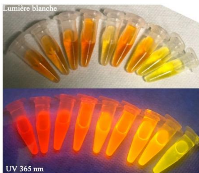
Figure 3.3 : En haut – Les 9 fractions de QDs AIS sous lumière blanche. En bas – les 9 fractions sous une excitation UV à 365 nm.
