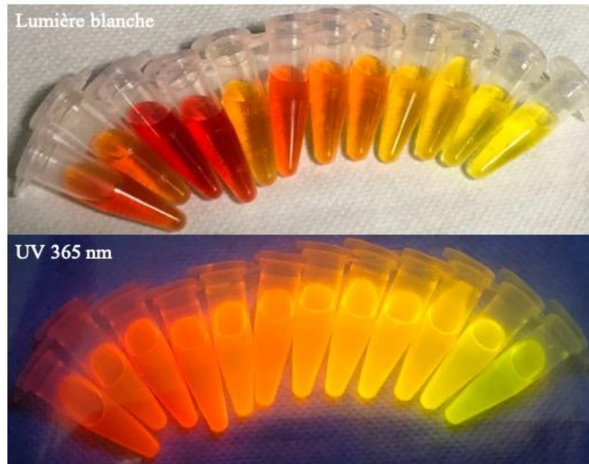
Figure 3.11 : En haut – Les 12 fractions sous lumière blanche. En bas – Les 12 fractions sous excitation UV à 365 nm.
