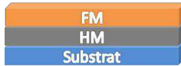
FIGURE 1.18 – Système de couches minces présentant un effet DMI composé d'une couche ferromagnétique (FM) en contact direct avec un métal lourd (HM).
