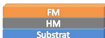
FIGURE 4.1 – Représentation schématique des couches minces étudiées. Une couche d'un matériau ferromagnétique (FM) est en contact direct avec un métal lourd (HM) afin d'induire un effet DMI.
