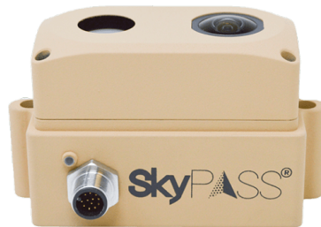
FIGURE 4.2 – Compas céleste SkyPASS Gen3 commercialisé aux États-Unis par Polaris Sensor Technologies, Inc.. Le module SkyPASS pèse \sim 370 g pour une taille de 8 \times 2,5 \times 5 cm. D’après polarissensor.com .
