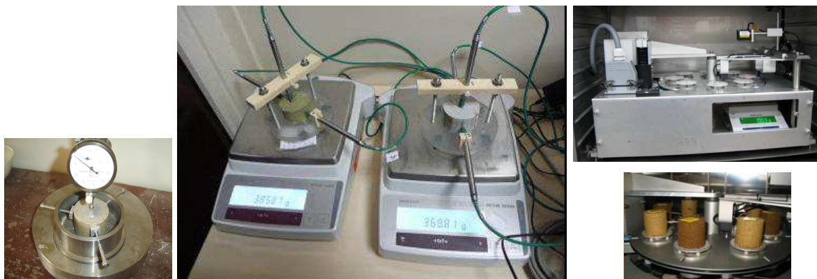
Figure 33. Photo du montage pour une mesure manuelle du retrait axial ( norme XP 94-060-1 ), du montage pour l'essai de retrait volumique automatisé mis en place à l'IFSTTAR et de l'appareil TYPOSOIL commercialisé par Sols Mesures (appareil développé par des pédologues avec des capteurs laser pour la mesure du déplacement axial et latéral, de capteur de succion et d'une mesure de la masse en continue).
