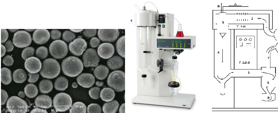
Figure 14. (a) Exemple de kaolinite conditionnée avec la méthode de séchage par pulvérisation (Hiller, 2002).
