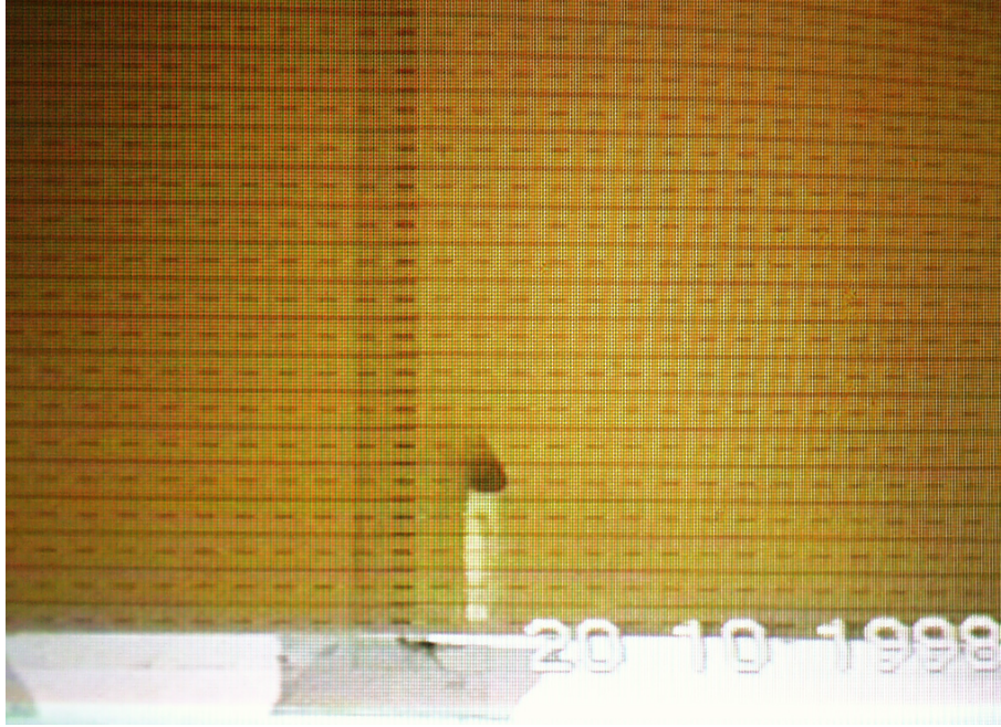
FIGURE 2.7: Photo prise pendant l'injection d'air dans la fissure. L'air injecté s'est accumulé à la pointe de la fissure et apparaît en sombre. Les marqueurs horizontaux tracés sur la paroi de la cuve permettent de mesurer la hauteur d'air accumulé à la pointe de la fissure (ici 1 cm). Le capillaire présent dans la fissure se devine à la coloration plus sombre de son extrémité : une bulle d'air est en train de s'y former et va s'en détacher.
