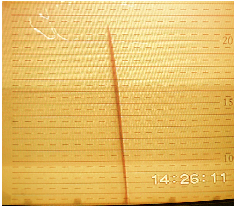
FIGURE 4.7: Photo prise lors de l'expérience (22) après 61 s de propagation. La fissure se caractérise par une tête plus épaisse que la queue. L'épaisseur de la tête est de 3 à 4 mm alors que l'épaisseur de la queue n'est que d'1 mm environ.
