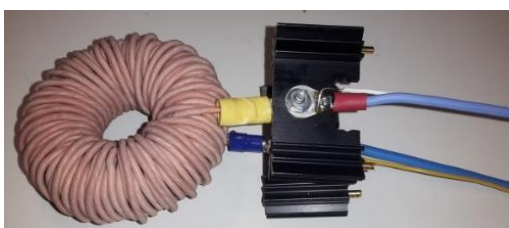
Figure 3.46 Inductance avec deux dissipateurs à l'interface avec les câbles
