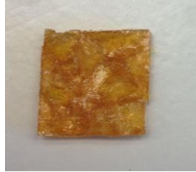
Figure 5-30 : Réparation sous presse à 130 °C pendant 30 minutes sous 60 bars des matériaux PUPShybr (1 : 2).
