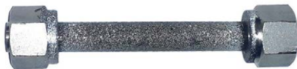
Figure 3.1 : Éprouvette avec les raccords sertis et le mouchetis.
