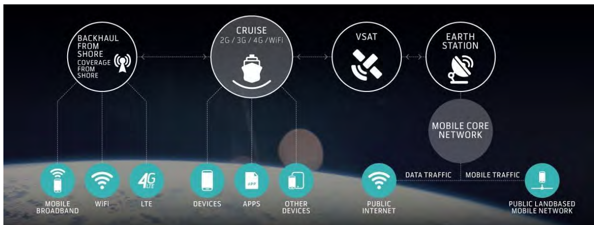
Figure 18 : Le système de communication maritime par satellite, intégrant le système VSAT
