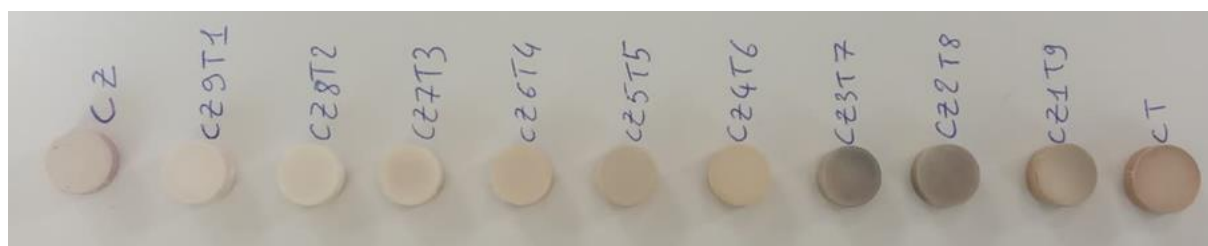
Figure 103 : Photographies des pastilles du domaine de composition \text{Ca}(\text{Zr}_x\text{Ti}_{1-x})\text{O}_3 obtenues après densification sous atmosphère réductrice
