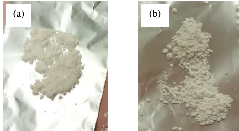
Figure 81 : Photos des poudres brutes issues de la Flash combustion avec l'utilisation du butoxyde de titane et sans combustible. (a) \text{Ca}(\text{Zr}_{0,8}\text{Ti}_{0,2})\text{O}_3 et (b) \text{CaTiO}_3 .
