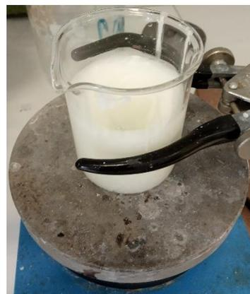
Figure 13 : Solution mise en agitation sur une plaque chauffante
