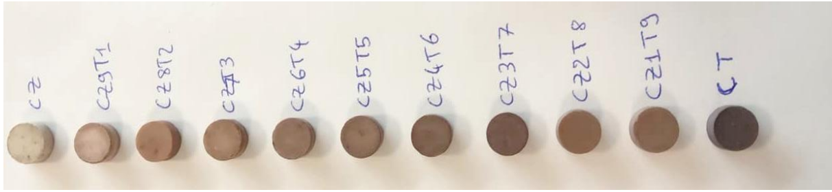
Figure 96 : Photographies des pastilles du domaine de composition \text{Ca}(\text{Zr}_x\text{Ti}_{1-x})\text{O}_3 obtenues
