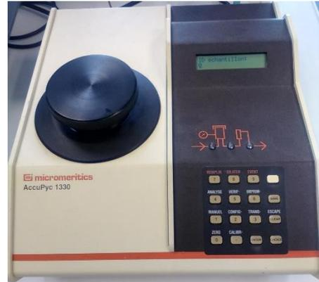
Figure 118 : Pycnomètre à Hélium
