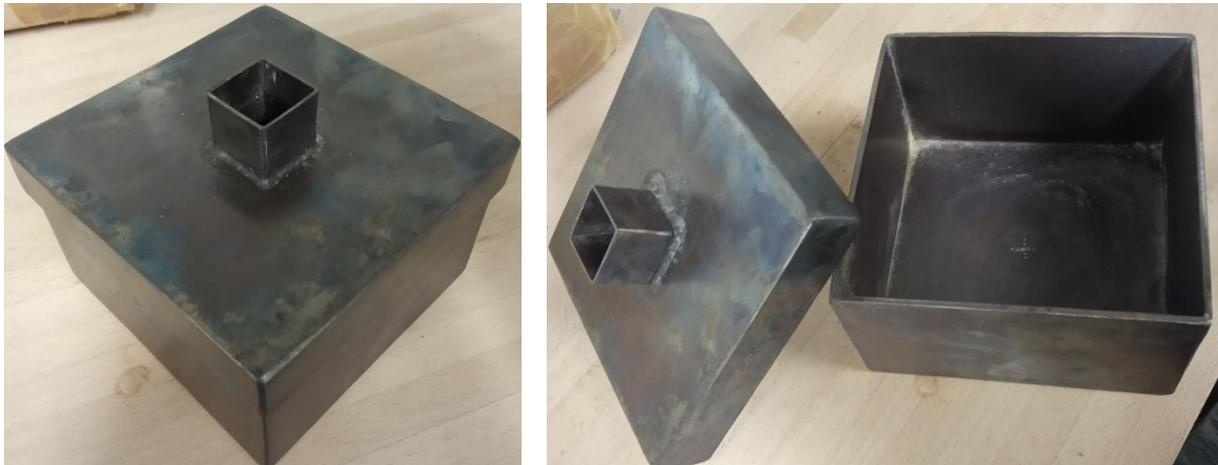
Figure 15 : Boîte où a lieu la réaction flash
