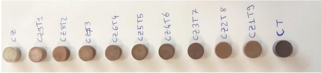
Figure 96 : Photographies des pastilles du domaine de composition  $\text{Ca}(\text{Zr}_x\text{Ti}_{1-x})\text{O}_3$  obtenues
