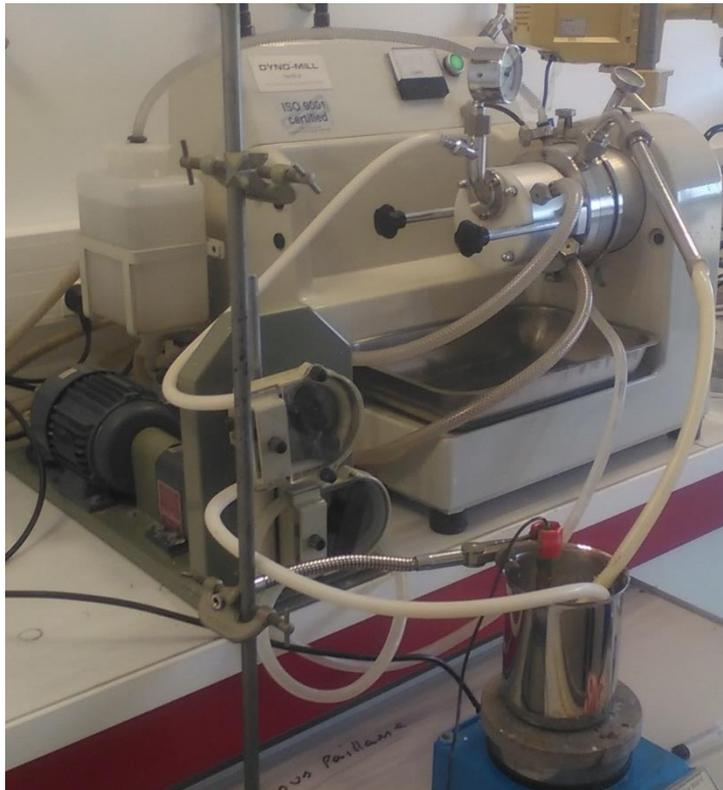
Figure 10 : Broyeur Dyno-mill
