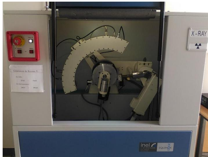
Figure 119 : Diffractomètre Inel Exquinoxe 3000
