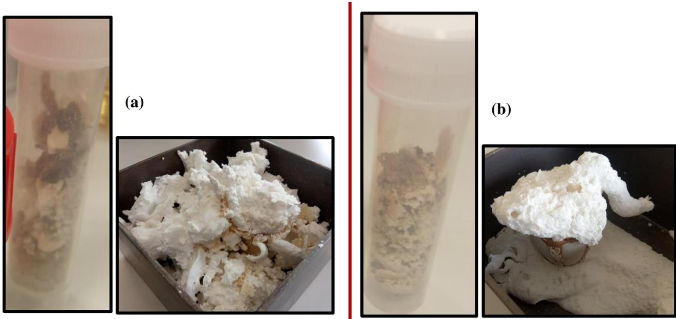
Figure 87 : Photo des poudres brutes issues de la Flash combustion avec l'utilisation de nitrate de titanyle avec la glycine en tant que combustible, (a)  $\text{Ca}(\text{Zr}_{0,5}\text{Ti}_{0,5})\text{O}_3$  et (b)  $\text{CaTiO}_3$
