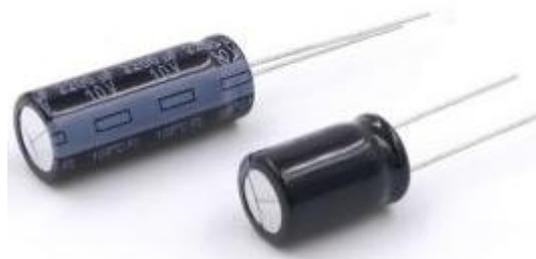
Figure 4 : Condensateur électrochimique
