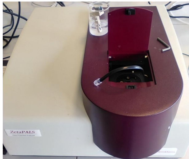
Figure 114 : Zétamètre ZetaPals avec cellule de mesure
