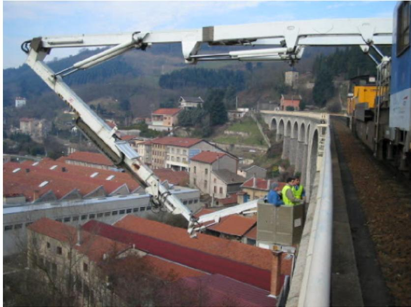
FIGURE 1.2 – Exemple d’inspection des ouvrages d’art (source internet)
