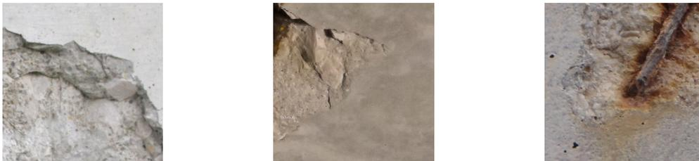
FIGURE 5.10 – Exemples d'images de notre base de données de défauts surfaciques.
