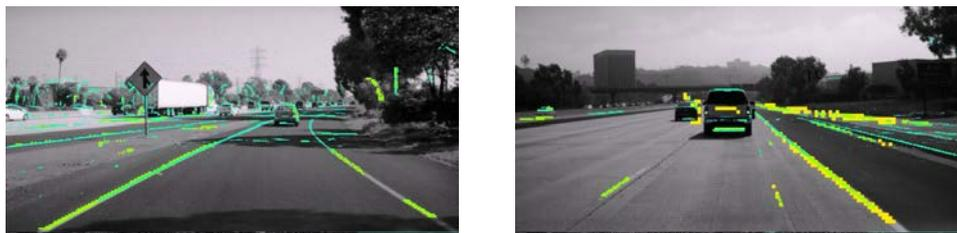
FIGURE 6.9 – Exemples de détection FLASH sur la base de données LISA
